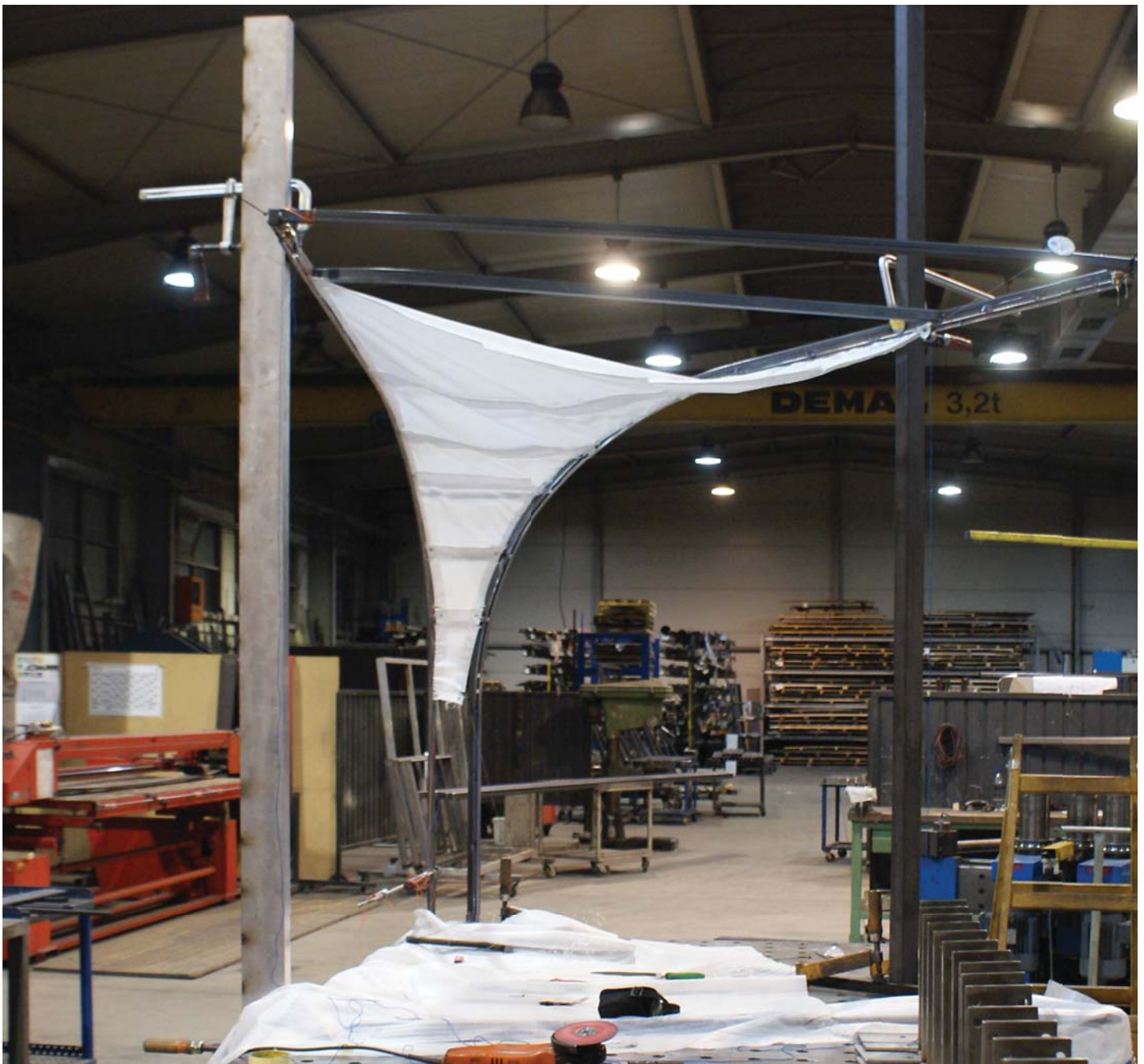
Abb. H.21. Gespannte Membran (Durchhängen aufgrund des falschen Zuschnitts)
