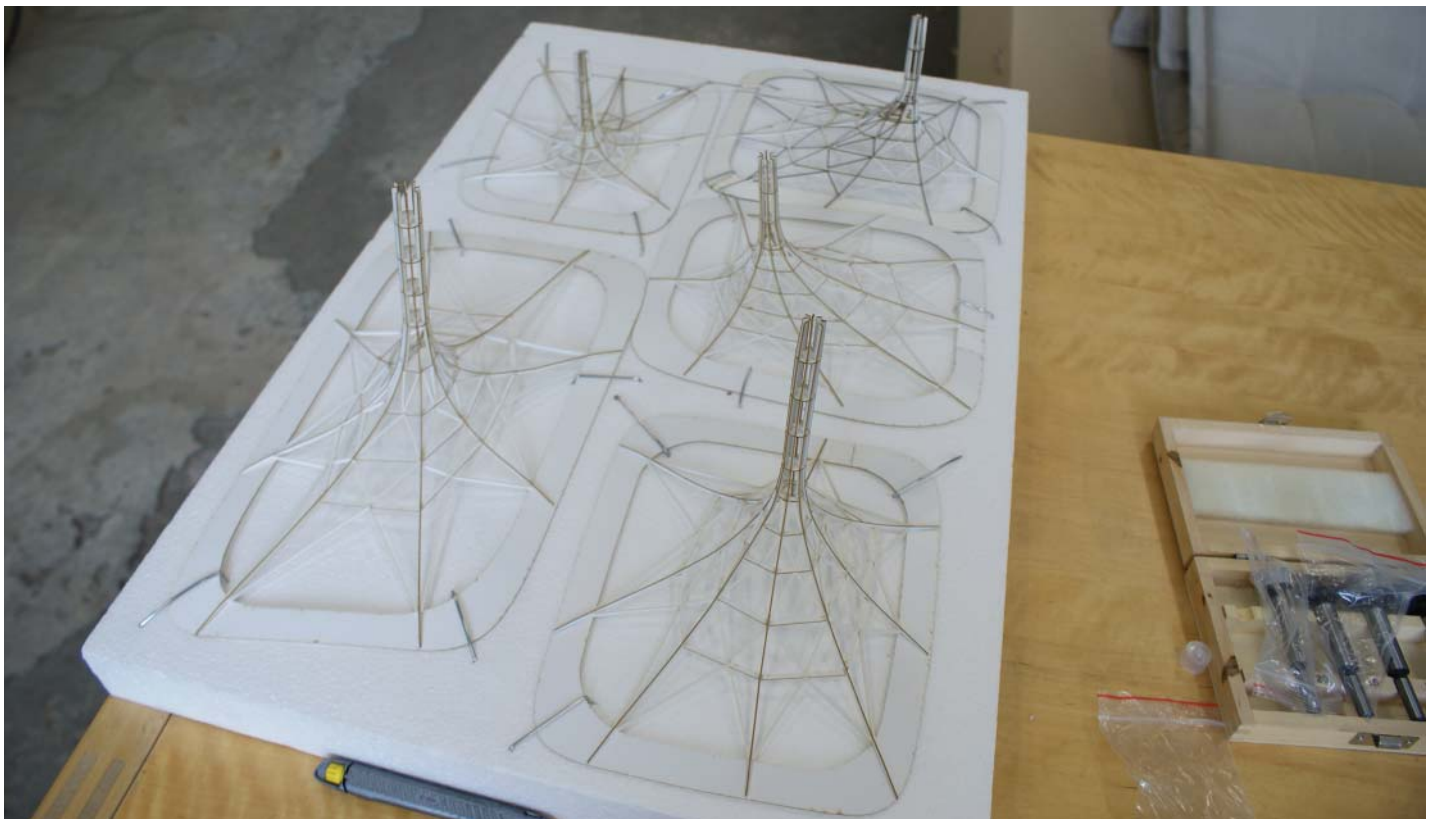
Abb. I.26. Transport der fertigen Schirmstrukturen (mit Draht auf einer Styroporplatte befestigt)
