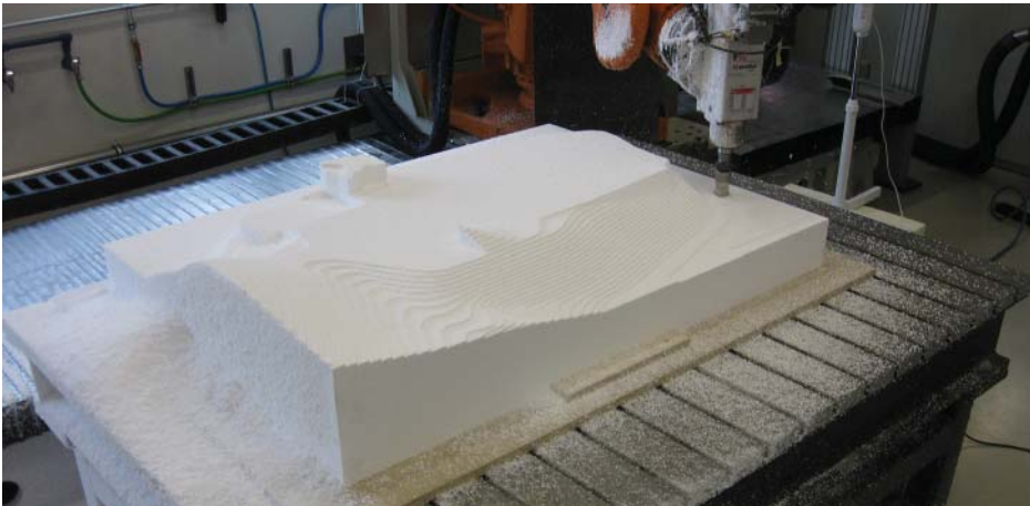
Abb. I.7. Abfräsen mit großen Fräskopf
