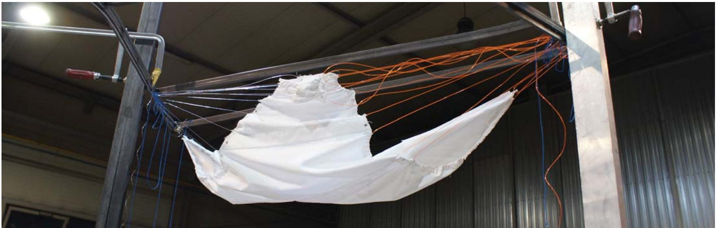
Abb. H.20. Gefaltete Membran verbunden mit beiden Schienen
