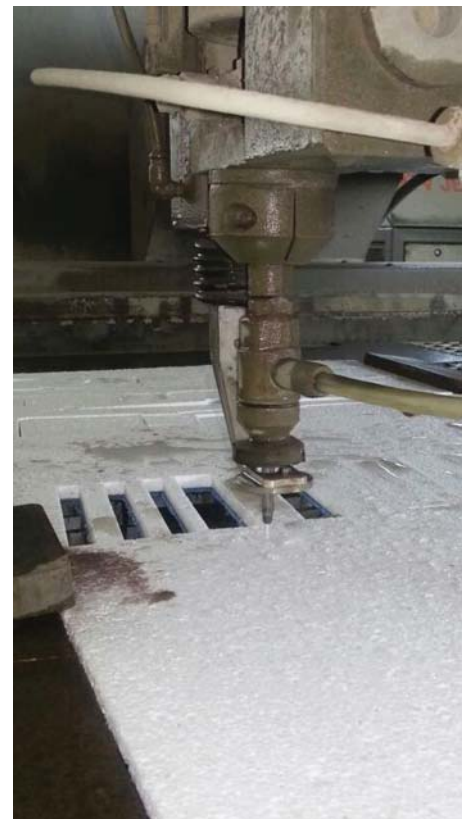
Abb. I.14. Schneiden der EPS-Platten
