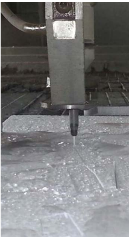
Abb. I.12. Schneiden der EPS-Platten
