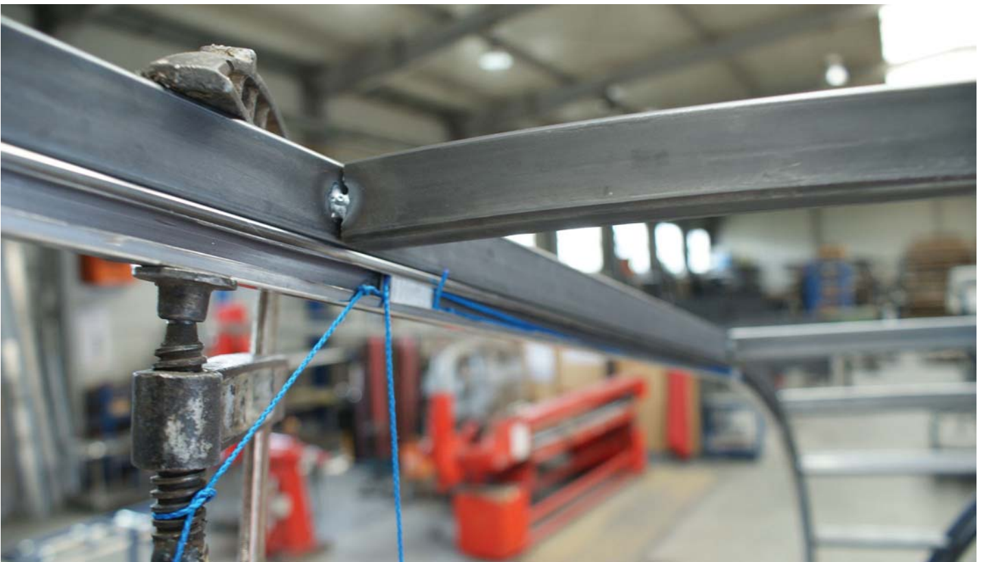
Abb. H.10. erste Versuche die Gleitelemente in den C-Profilen zu führen
