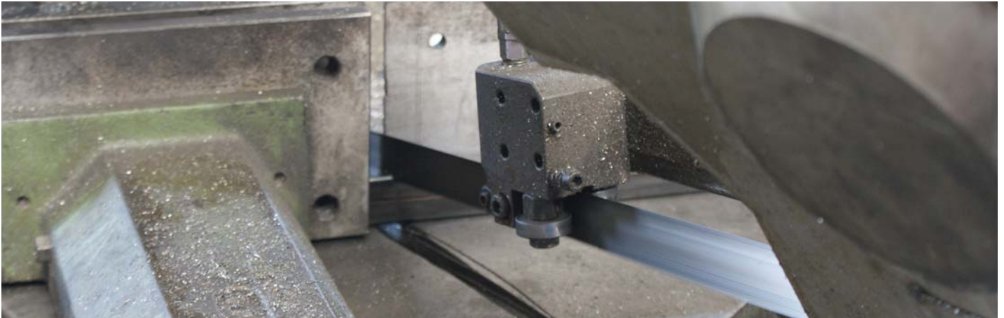
Abb. H.3. Schneiden eines Stabes
