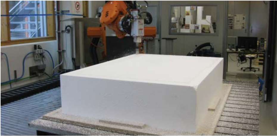
Abb. I.6. ausgerichteter EPS Block auf Trägerplatte
