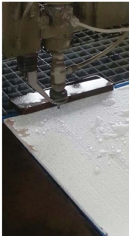
Abb. I.13. Schneiden der EPS-Platten
