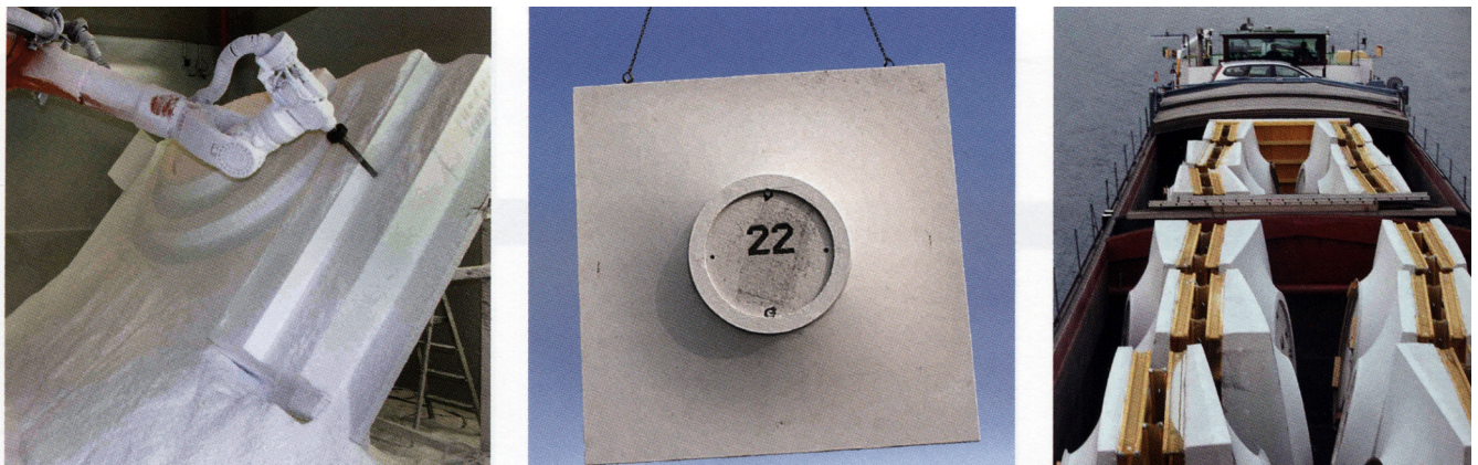
Abb. 049: Fräsung und Transport der Schalungselemente
