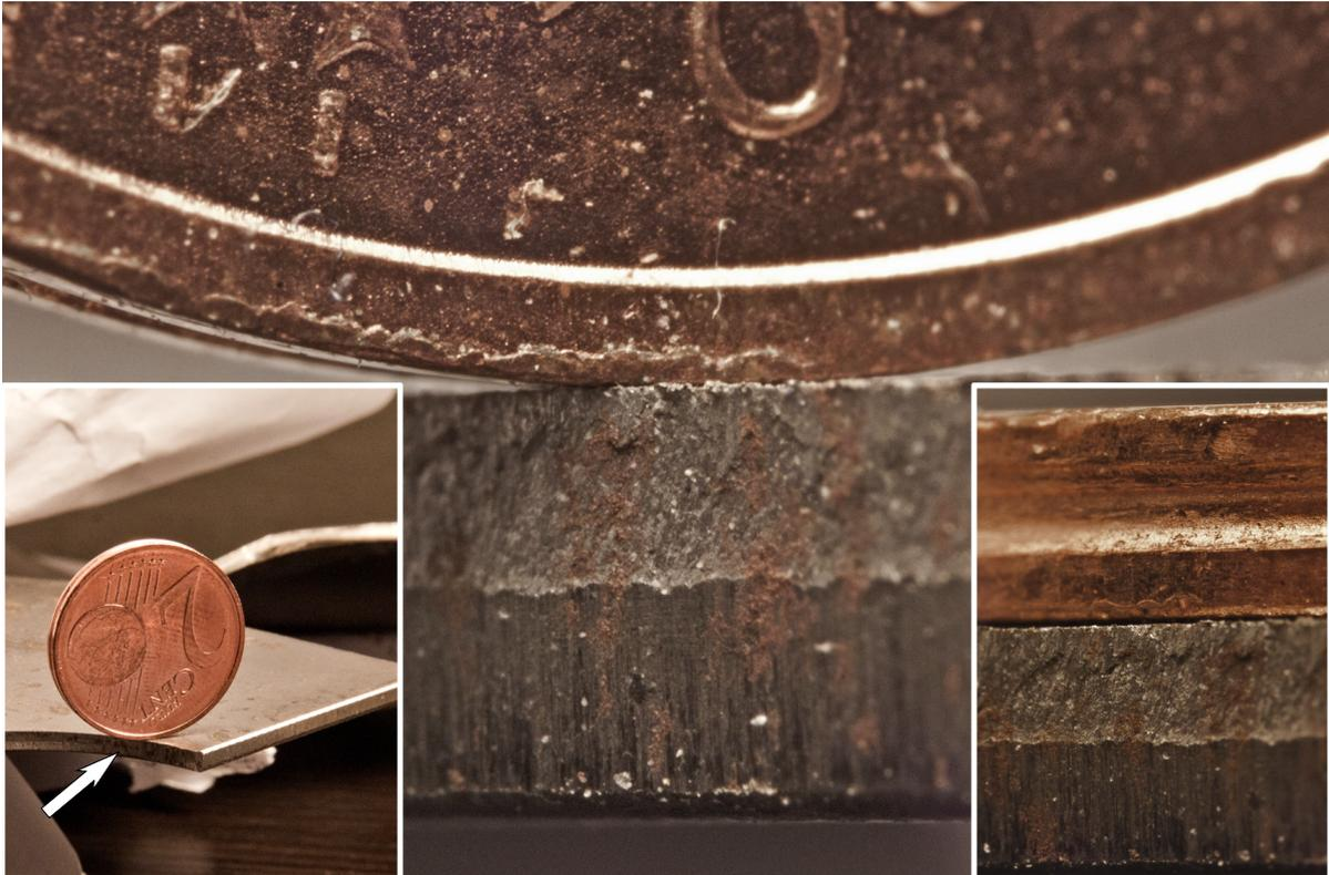
Abbildung 5.9: Makroaufnahme der Laserschnittoberfläche
