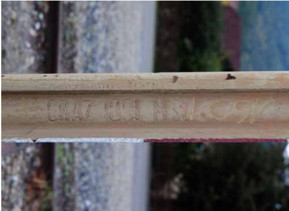
Abb. 36: Walzzeichen einer Schiene des Schienenwalzwerkes der Südbahn
