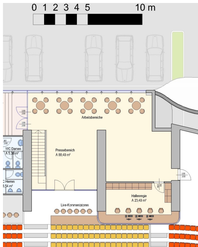
Fig. 78: Das Obergeschoss des Pressebereiches mit den Arbeitsbereichen oben, unten rechts dem Raum für die Hallenregie, angrenzend der Bereich für die Livekommentatoren und unten dem Sitzplatzbereich
