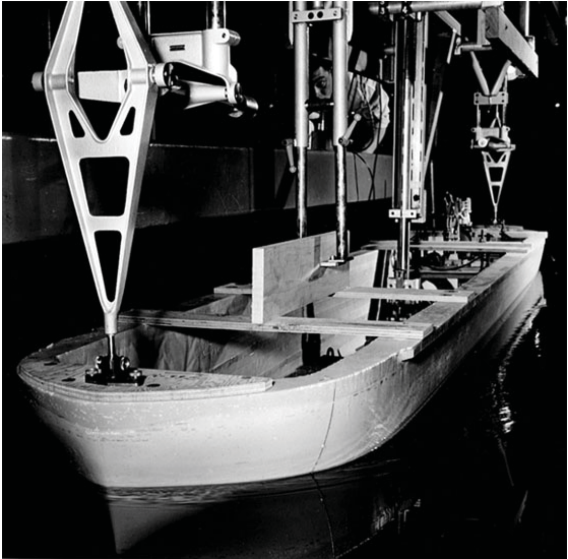
Abb 54: Modellversuch im Versuchsbecken von Michigan
