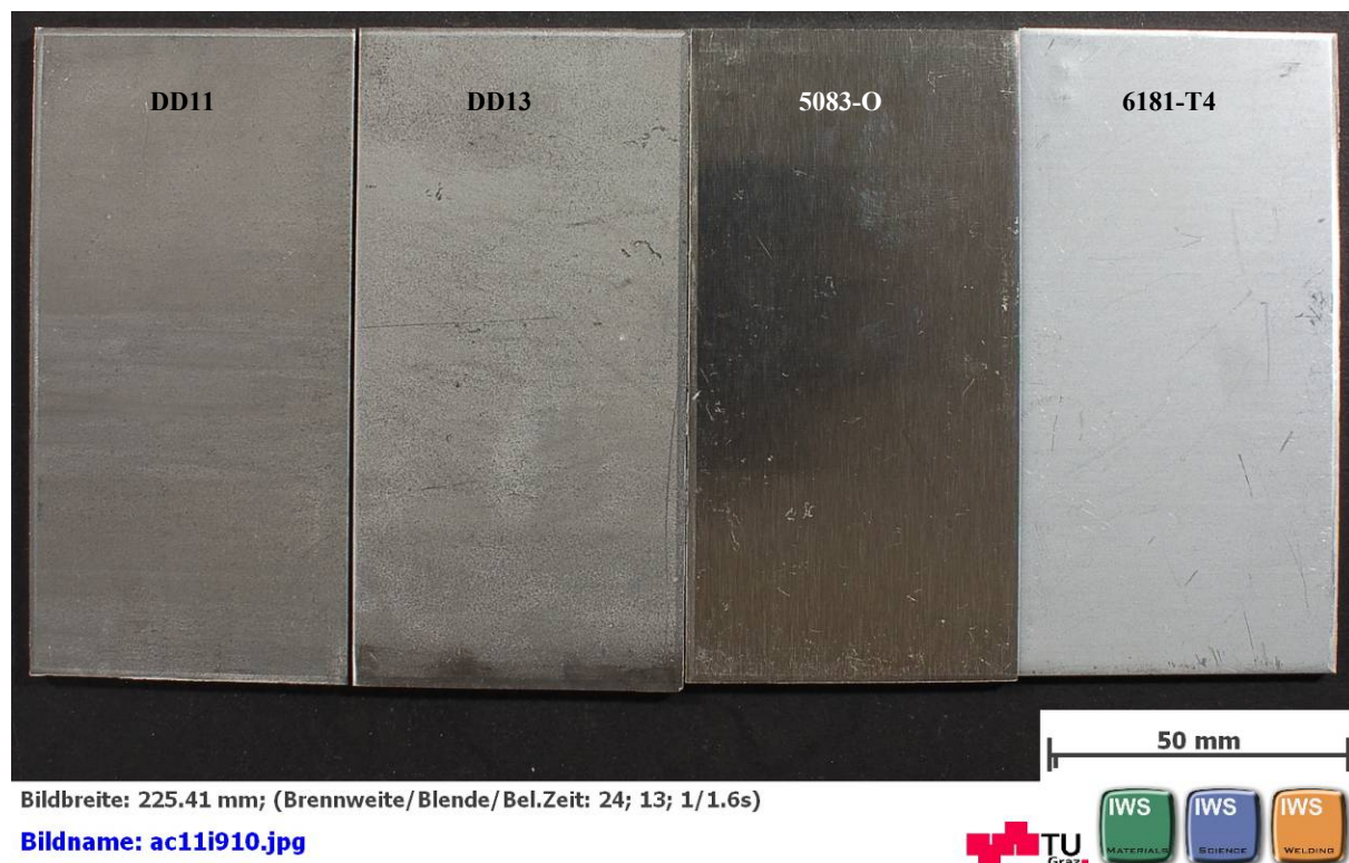
Abbildung 3.86 Korrosionsproben vom Grundmaterial vor dem NSS Test
