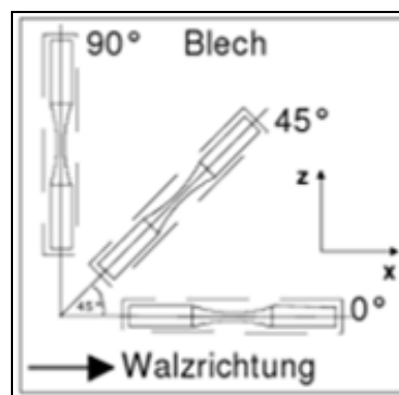
Abbildung 3.73 Probenlage bei der Ermittlung der Anisotropiewerte [Doege E. Behrens B.-A. 2010, S.300ff]
