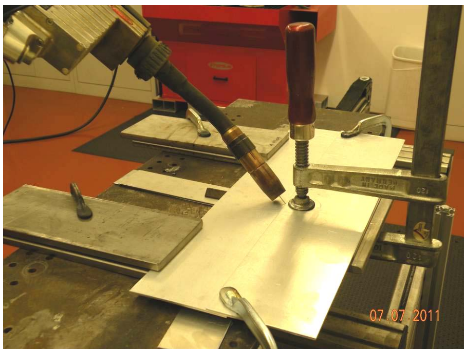
Abbildung 3.34 Versuchsaufbau der Hauptschweißversuche mit eingespanntem Versuchsblech
