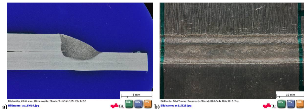
Abbildung 3.68 Ergebnis Parameteroptimierung für AW-5083-O/AlMg5 (Optimale Naht 8: 50Ar/50He%, v=30mm/s, 5°schleppend, E=138J/mm) a) Querschliff, b) Nahtoberfläche
