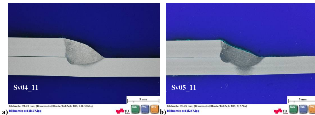
Abbildung 3.52 Einfluss des Schutzgases auf den Nahtquerschnitt von AW-5083-O/AlMg5 bei v=30mm/s, 5° stechend u. E=138J/mm a) 100%Ar, b) 50Ar/50He%-Gemisch
