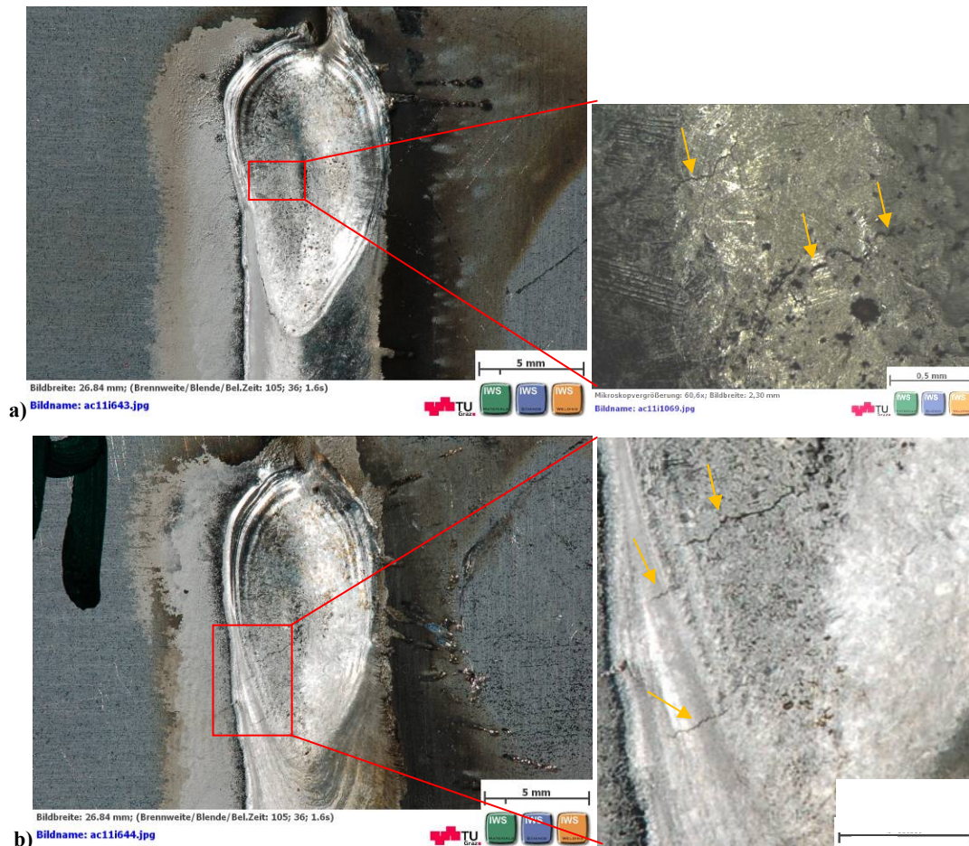
Abbildung 3.50 Einfluss der Pulskorrektur auf die Bildung von Endkraterrissen beim Schweißen von AW-6181-T4/AlSi5 a) ohne Pk, b) mit Pk=+1,8
