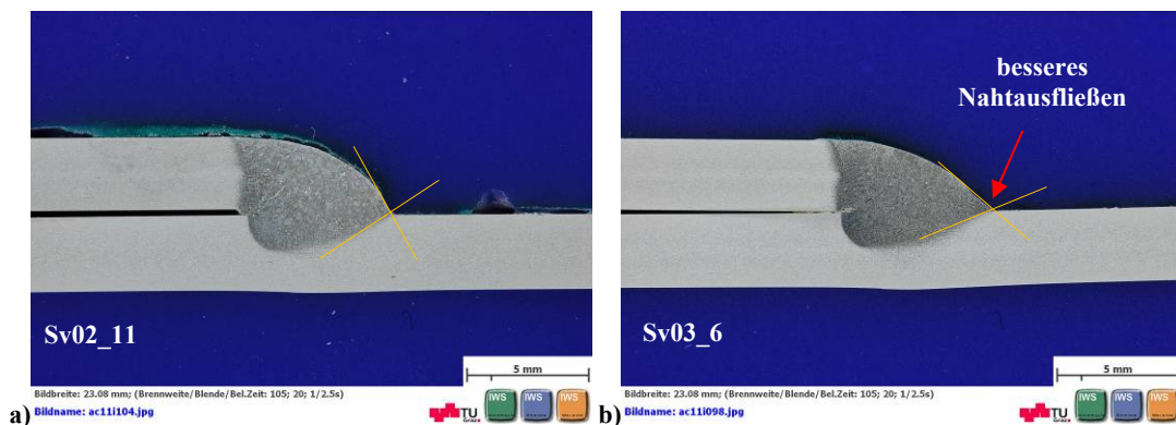
Abbildung 3.46 Einfluss der Pulskorrektur auf den Schweißnahtquerschnitt von AW-5083-O a) PK=0 b) PK=+2,1
