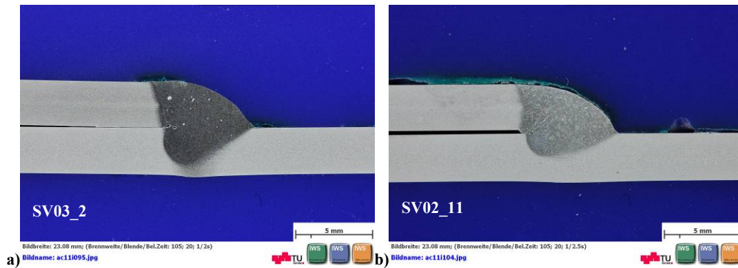
Abbildung 3.40 Vorstudie: Einfluss der Streckenenergie auf die Nahtgeometrie. a) 178,1 J/mm b) 173,3 J/mm
