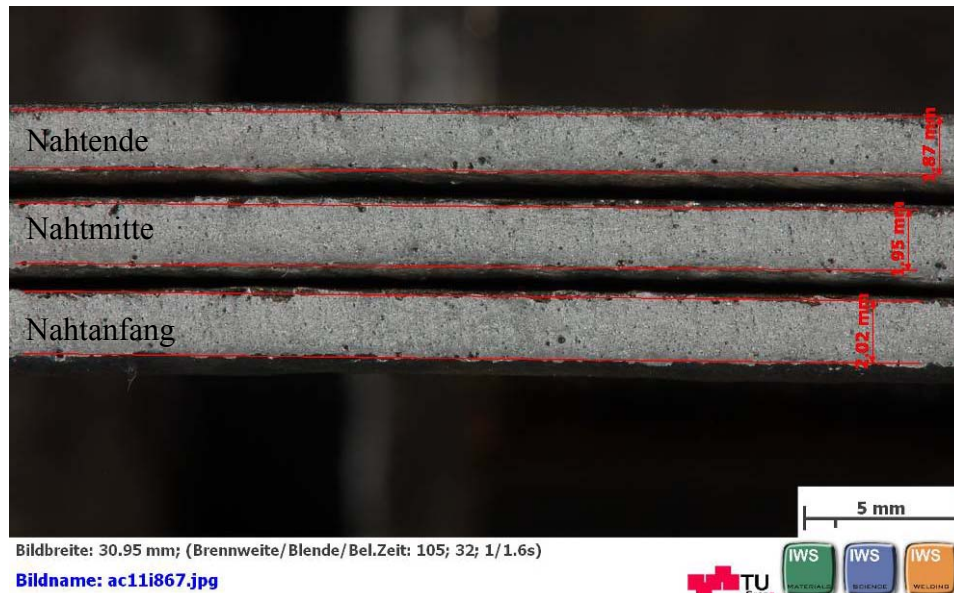
Abbildung 3.37 Bruchflächenauswertung von den drei Scherzugproben einer Naht; AW-5083-O mit SZ AlMg5
