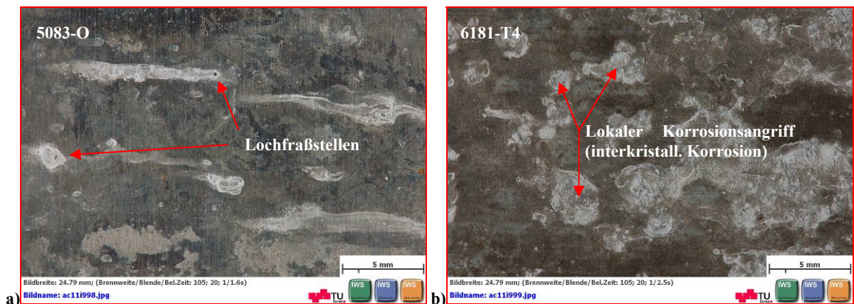
Abbildung 3.88 Detailaufnahme der Korrosionserscheinungen a) Lochfraßstellen von AW-5083-O, b) Lochfraßstellen als Ausgangspunkt der interkristallinen Korrosion bei von AW-6181-T4
