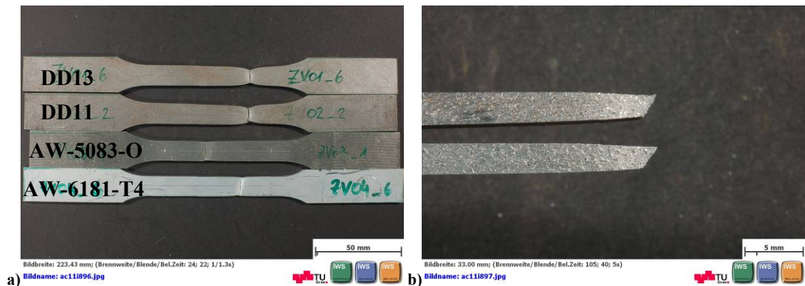
Abbildung 3.74 gebrochene Flachzugproben a) Vergleich aller Werkstoffe b) Scherbruch einer Flachzugprobe (AW-5083-O)
