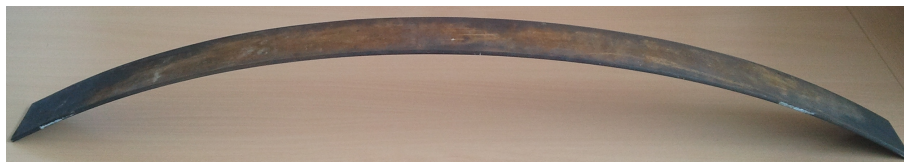
Abbildung 5.2.: Ersatzblattfeder aus Federstahl
