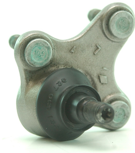
Abbildung C.3.: Traggelenk mit Gussgehäuse und integrierter Verschraubung
