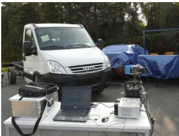
Abbildung 6-1: 3D-Scan des Iveco Fahrgestells
