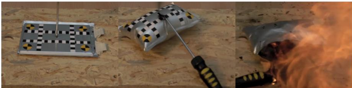
Abbildung 9-1: Bildfolge Anstechen einer Zelle
