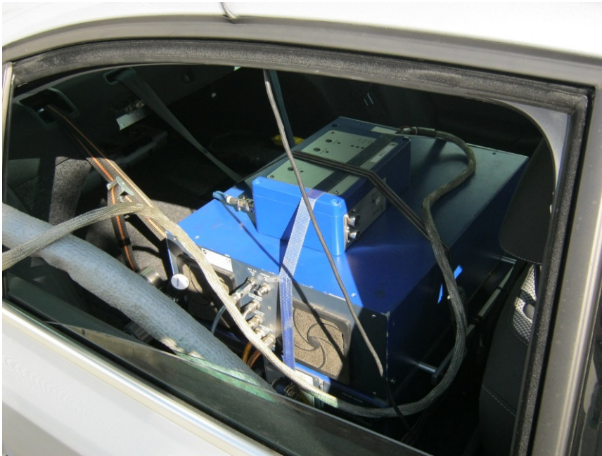
Abbildung 35: Messaufbau (3/4): Messtechnik auf der Rücksitzbank und im Kofferraum (Fotografiert durch die fahrerseitige hintere Scheibe)
