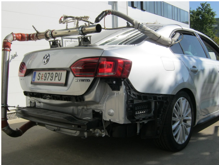
Abbildung 34: Messaufbau (2/4): Messstrecke ab Auspuff (Rohr) und Verbindungen zu den Analysatoren im Inneren (Leitungen)
