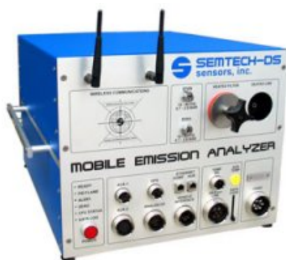
Abbildung 32: Portables Emissions-Messsystem SEMTECH-DS (Quelle: http://www.environmental-expert.com )
