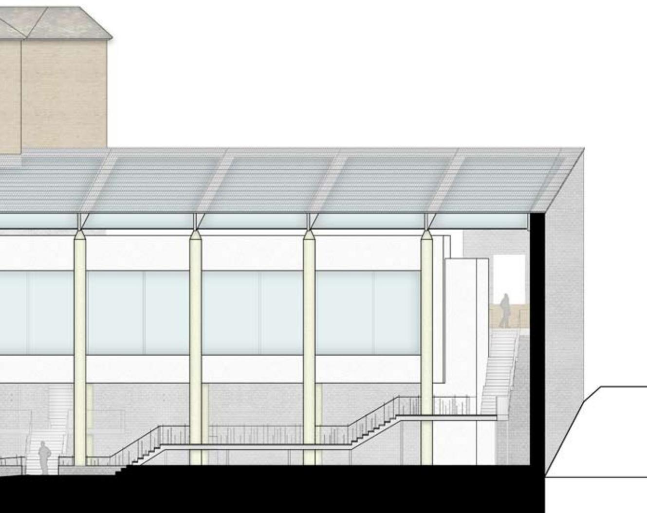
Abbildung 114: Querschnitt durch die Lounge mit Ansicht auf den Speisesaal, M1:200
