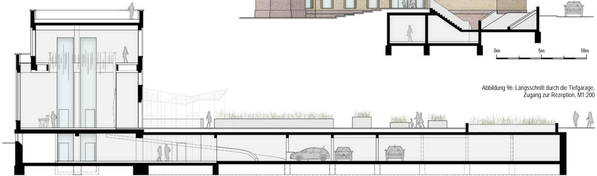
Abbildung 96: Längsschnitt durch die Tiefgarage,
