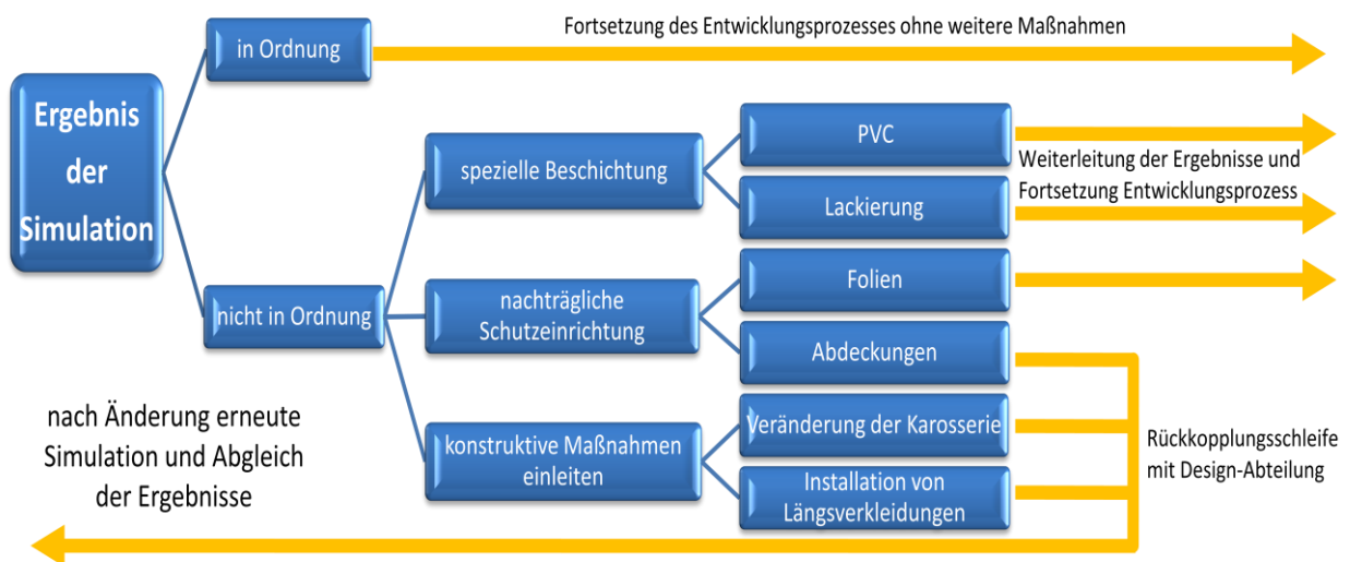
Abb. 6.1 Einbindung der Steinschlagsimulation im Fahrzeugentwicklungsprozess
