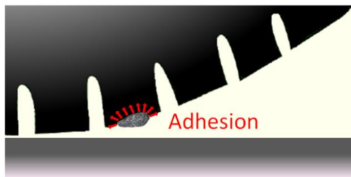
Abb. 2.2 Steine haften auf der Reifenoberfläche [3]
