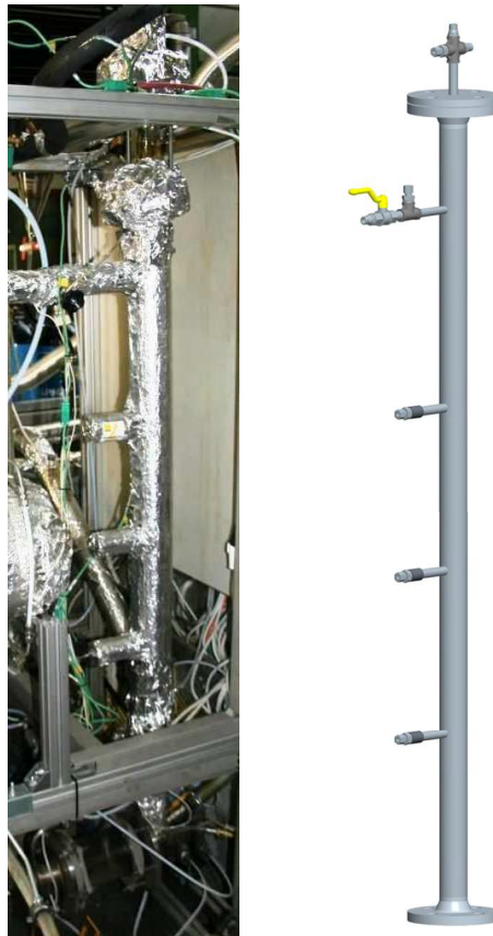
Abbildung 4.7: Foto und 3D-CAD-Zeichnung der Kolonne
