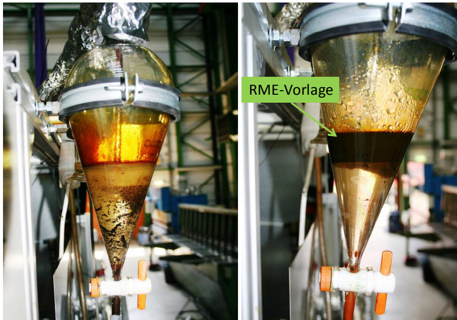
Abbildung 6.27: Versuch 06 – Trichterabscheider der Waschflaschen: links: nach 46 Bh, rechts: nach ca. 50 Bh mit RME-Vorlage
