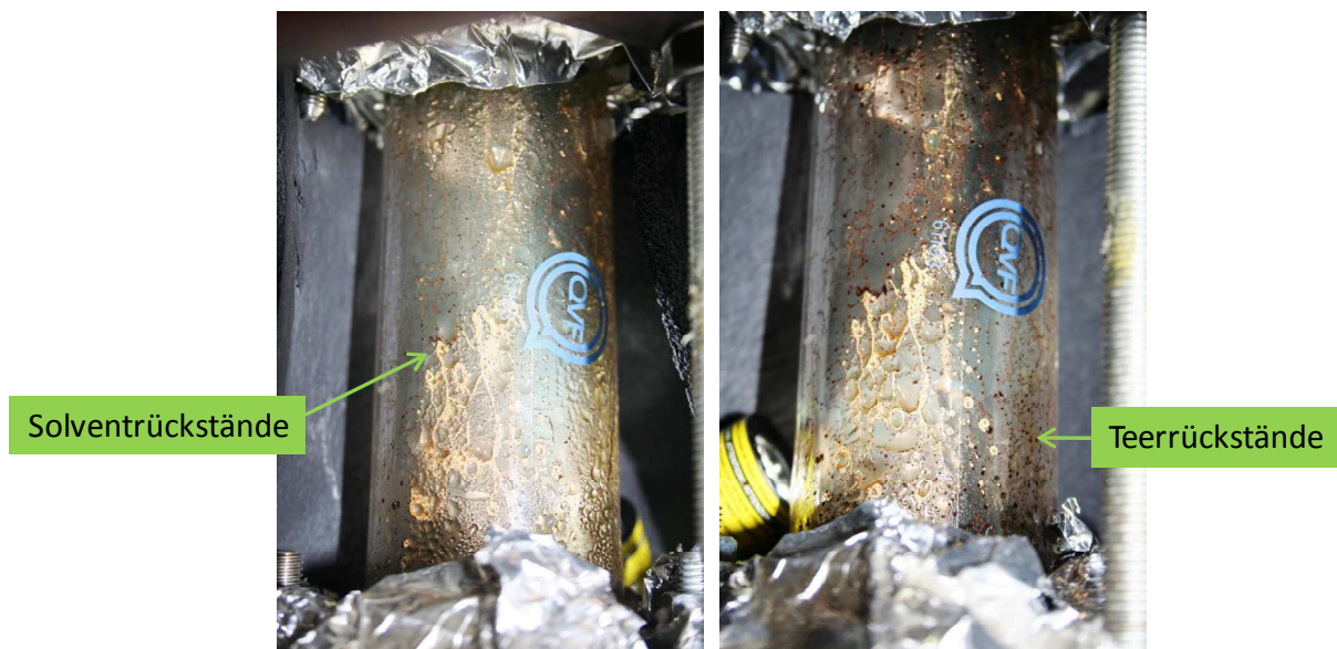
Abbildung 6.20: Versuch 05 – „Schauglas“, links: nach 26 Bh, rechts: nach 50 Bh
