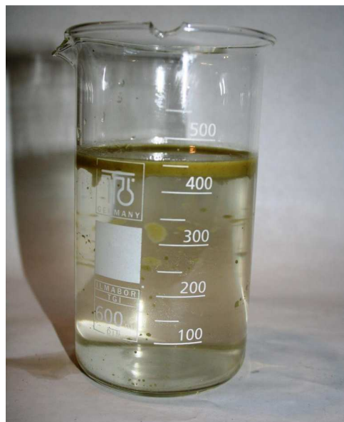
Abbildung 6.17: Versuch 04 – Kondensatwasserentnahme Absetzbecken mit aufschwimmender Emulsionsschicht
