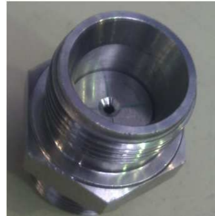
Abbildung 4-2: Eingebaute Fixdrossel im Inneren eines Verbindungsstücks
