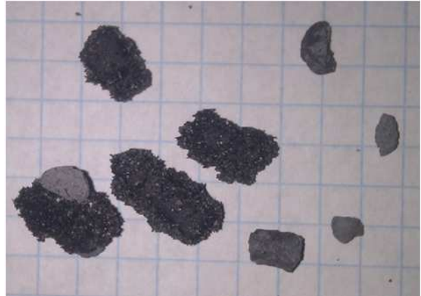
Abbildung 5-47: Agglomerationen nach Klärschlamm pelletsversuch V1
