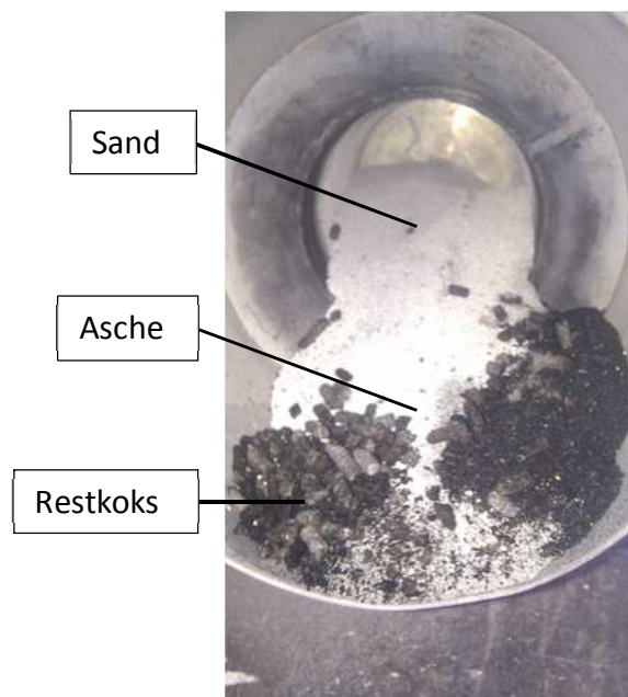
Abbildung 5-12: Geöffneter Reaktor nach Pelletsversuch V4
