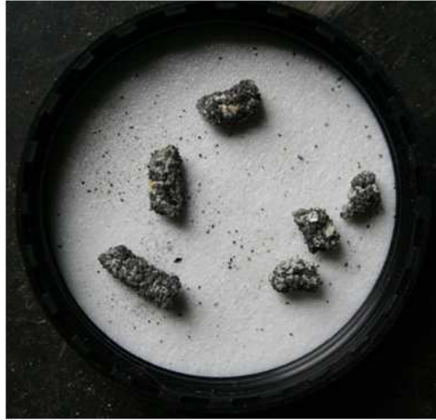
Abbildung 5-39: Ascheschmelzverhalten bei Gärrestpellets
