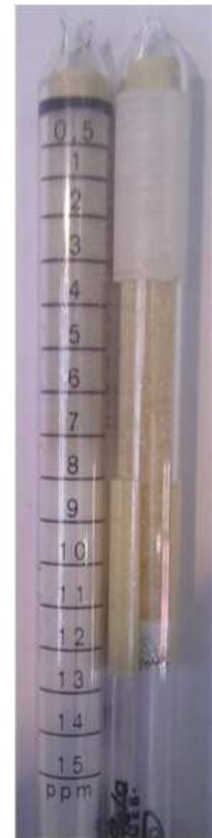
Abbildung 4-11: Dräger- Messröhrchen zur Detektion von H_2S und Olefinen im Gas
