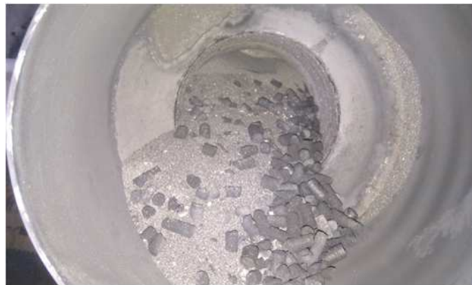
Abbildung 5-46: Geöffneter Reaktor nach Klärschlammpelletsversuch V1
