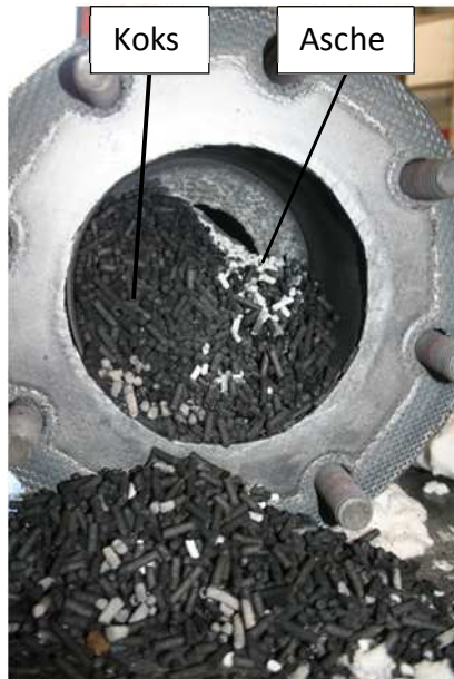
Abbildung 5-23: Geöffneter Reaktor nach Graspelletsversuch V4
