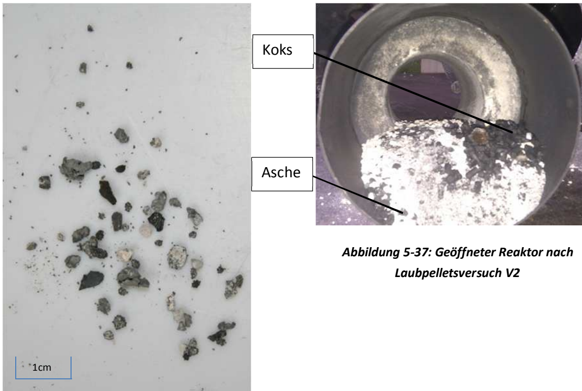
Abbildung 5-36: Agglomerationsbildung - Laubpelletsversuch V2
