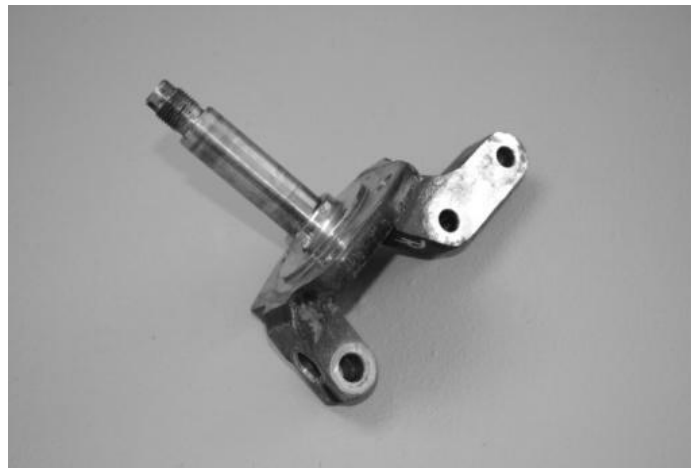
Abbildung 3.4: Schwenklager mit Zapfen (Werkstoff Stahlguss), Tato Nano Bj. 2010, [3]
