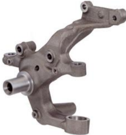
Abbildung 3.13: VW-Golf Hinterachsradsradträger aus Sibodur 700-10, [22]
