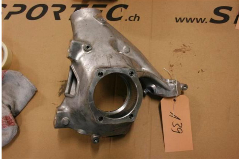
Abbildung 3.5: Porsche Boxster Radträger der Hinterachse, Werkstoff: AlSi7MgTi
