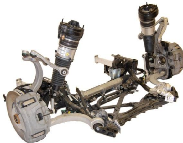
Abbildung 2.7: 5-Lenker Vorderachse des Audi A8 4.2, Bj:2010, [3]
