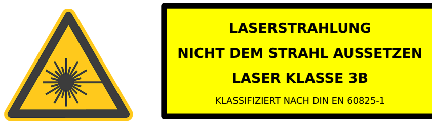
Abbildung 3.1: Hinweisschilder für Laserschutzbereich und Beschriftung des Lasers
