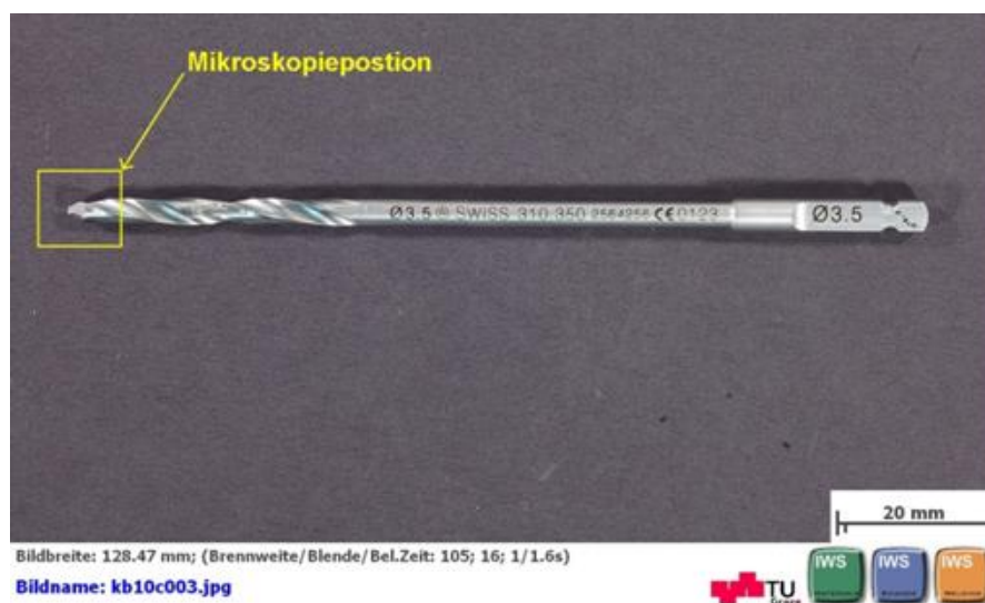
Abbildung 14: Chirurgischer Standardknochenbohrer von Synthes Swiss
