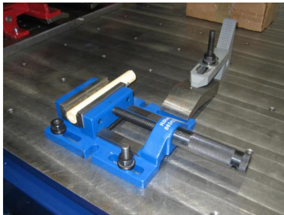
Abbildung 41: Kunstknochen in Spannvorrichtung
