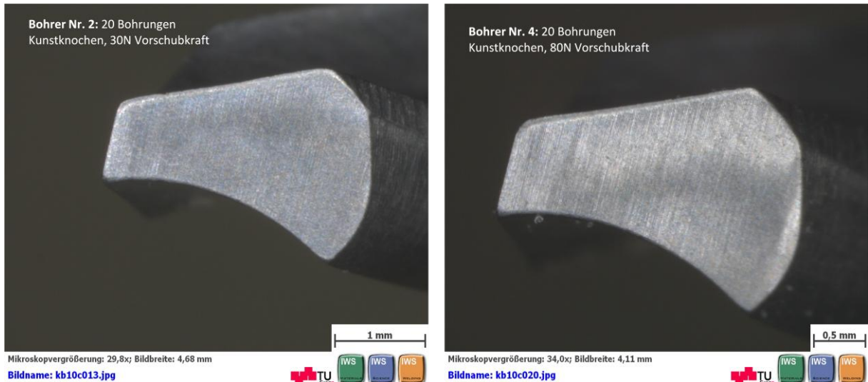
Abbildung 49: Verschleiß durch Kunstknochen bei Vorschubkraft_30N und 80N
