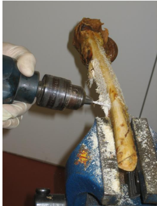
Abbildung 72: Belastungsbohrung mit Brasseler CeraDrill per Hand
