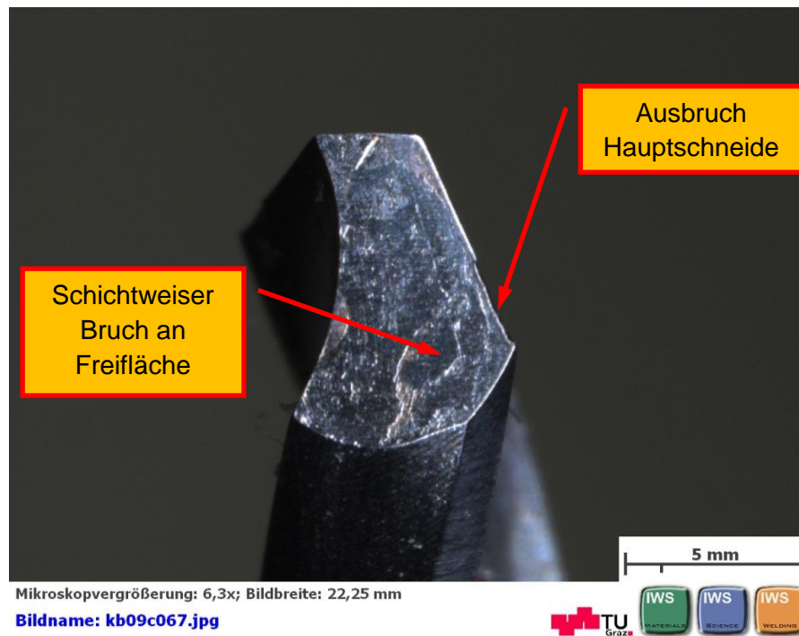
Abbildung 54: Verschleißerscheinungen am Knochenbohrer 1
