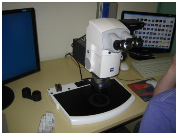
Abbildung 46: Untersuchung des Verschleißes mittels Stereolichtmikroskopie
