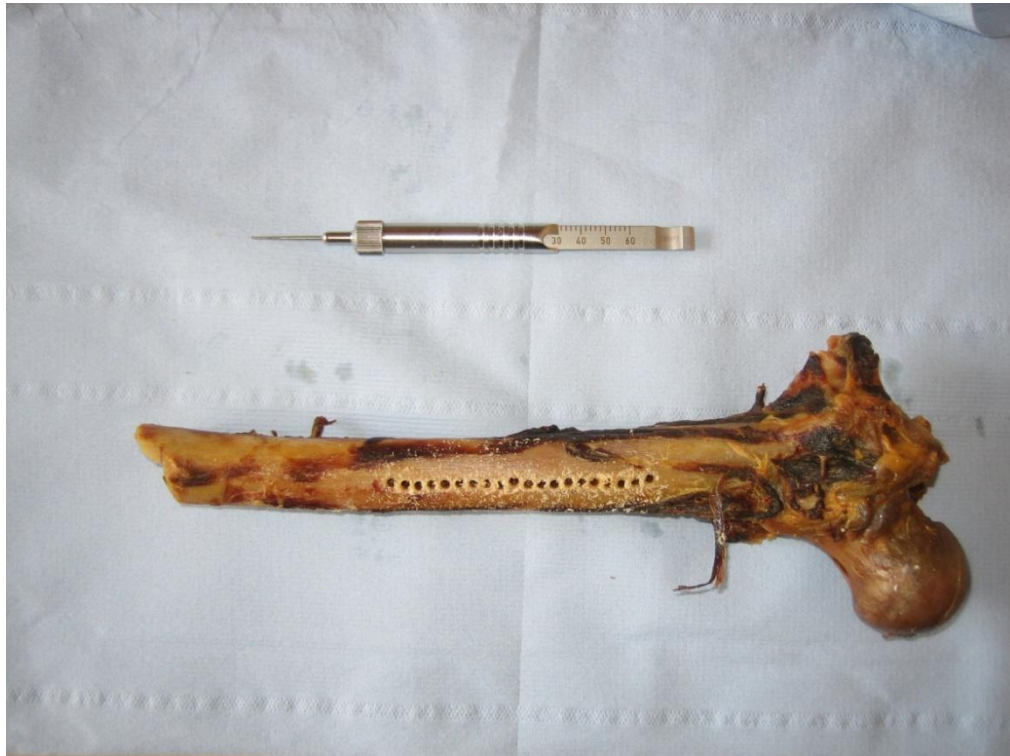
Abbildung 47: Messung der Kortikalisdicke mittels eines Kortikalisdicken-Messgeräts
