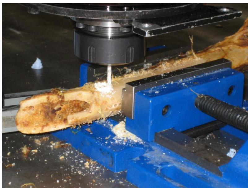
Abbildung 71: Belastungsbohrung mit Brasseler CeraDrill an der FSW-Anlage
