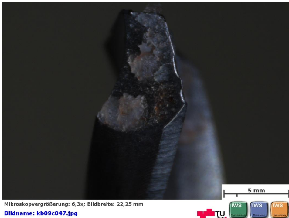
Abbildung 38: AISI 440A: Verschleiß nach 33 Bohrungen in Schweineknochen
