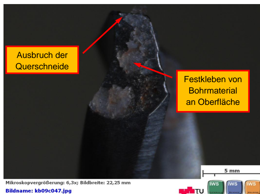
Abbildung 55: Verschleißerscheinungen am Knochenbohrer 2
