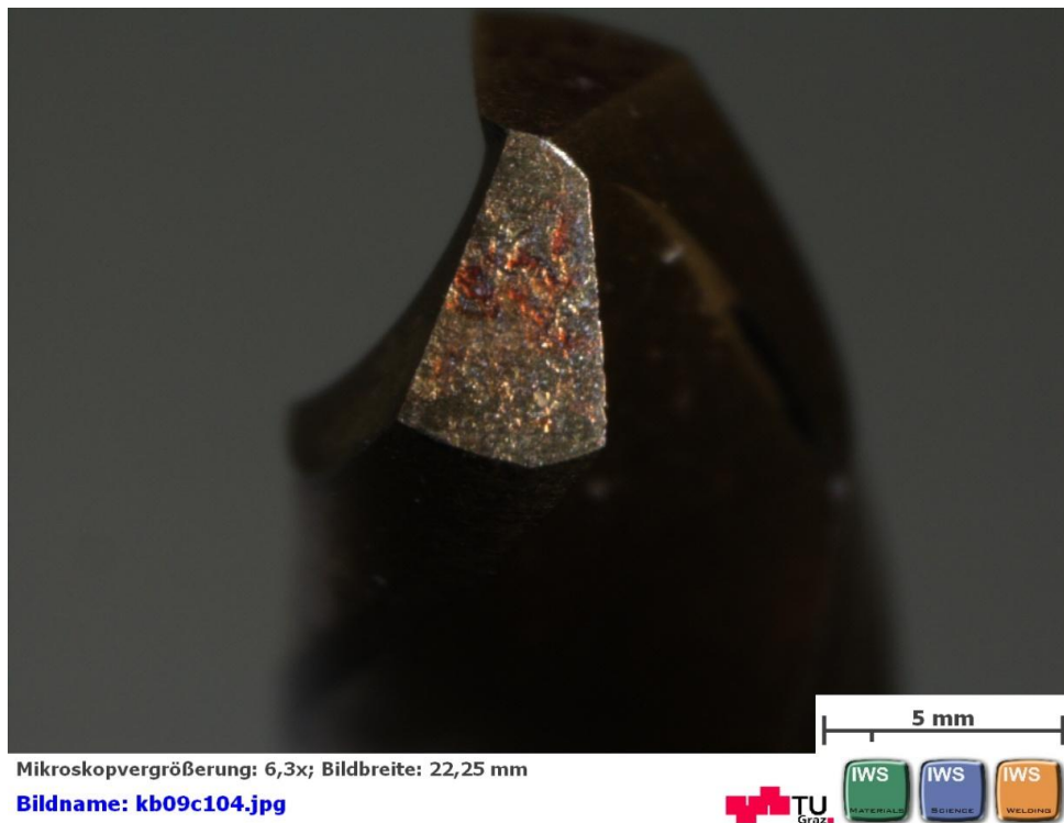
Abbildung 40: HSS TiN: Verschl. nach 39 Bohrungen in Kunst- und 12 in Schweinekn.
