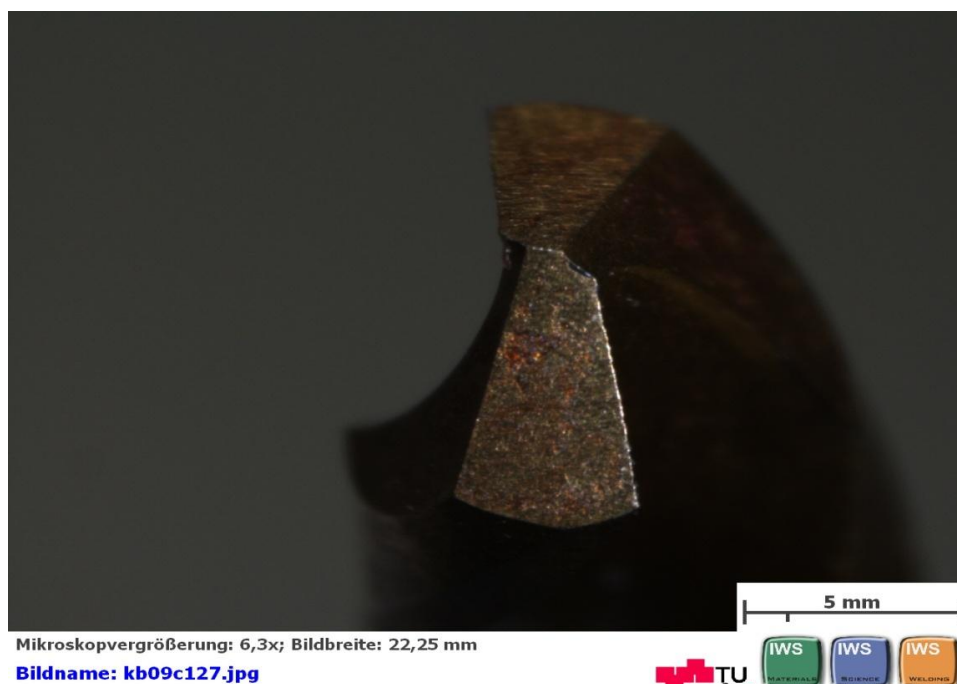
Abbildung 39: HSS TiN: Verschleiß nach 15 Bohrungen in Schweineknochen
