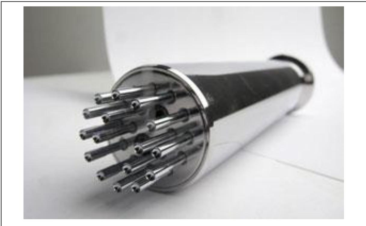
Abbildung 24: Multi-Tip Tool der Unternehmung I Holland<sup>76</sup>
