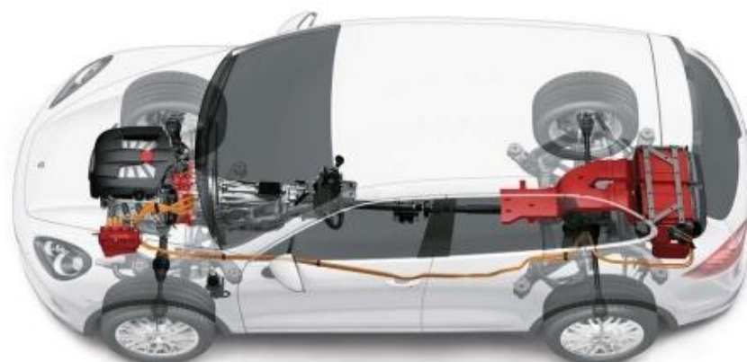
Abbildung 6-2: Antriebsstrang des Porsche Cayenne S Hybrid (Porsche, 2010)
