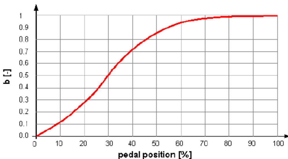
Abbildung 6-12: Korrekturfaktor zur Berechnung des Motormoments in Abhängigkeit von der Fahrpedalposition (AVL, 2011)
