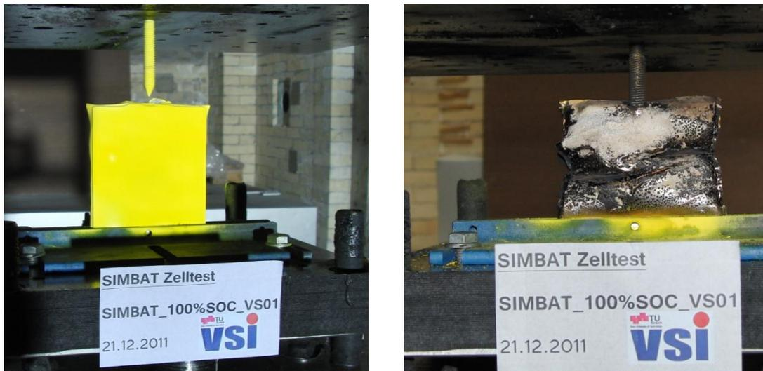
Abbildung 8: Penetrationstest an einer Lithium-Ionen Zelle (Hazard Level 6) vor (links) und nach (rechts) dem Versuch
