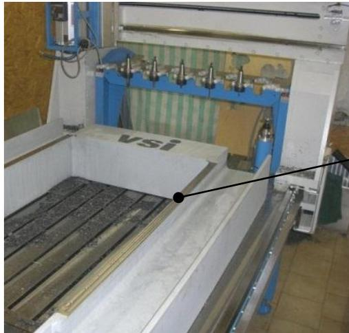
Bearbeitete Fläche zur Montage der Führungsschiene des Linearführungssystems
