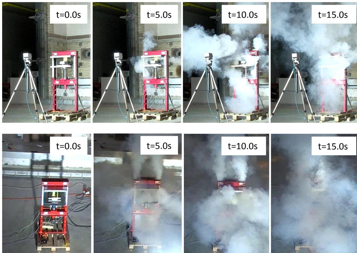
Abbildung 13: Ausgasen der Versuchszelle 0, 5, 10, 15 Sekunden nach optischer Erkennung des Ausgasens, Betrachtung seitlich (obere Bildfolge) und von Oben (untere Bildfolge)
