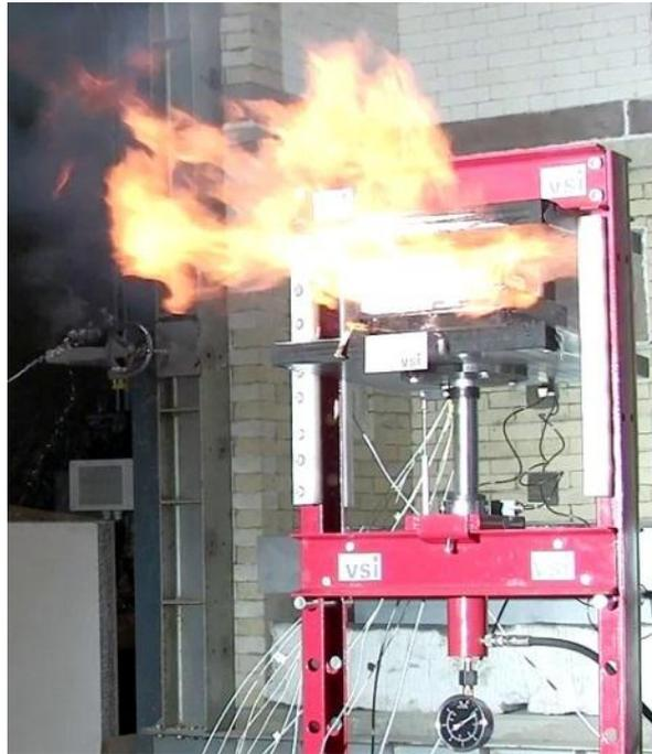
Abbildung 14: Brand einer Lithium-Ionen Zelle
