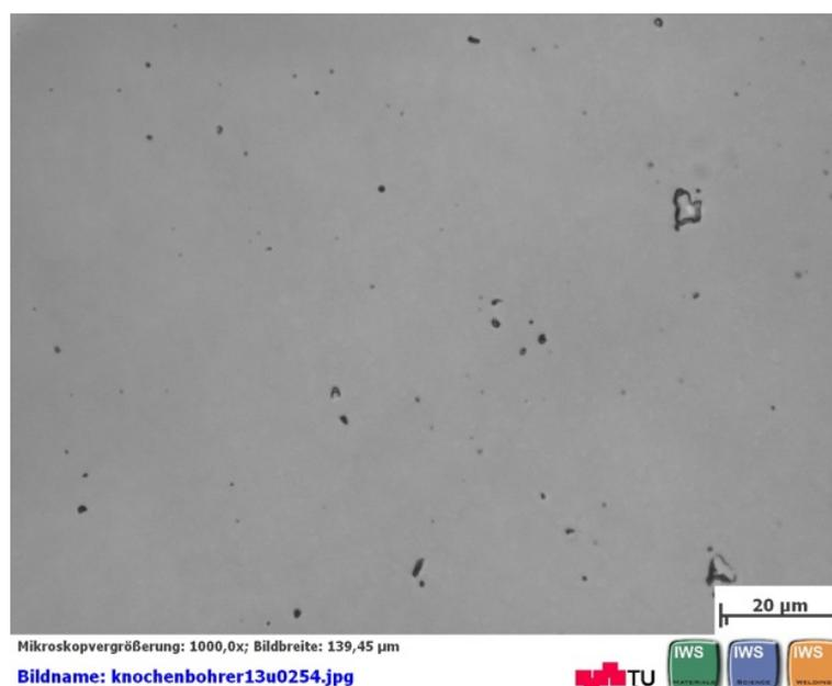
Abbildung 41: Poren am Querschliff
