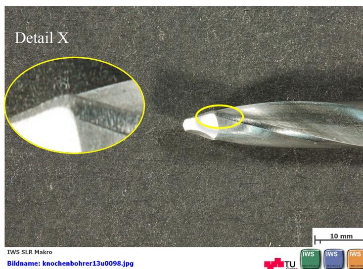
Abbildung 78: Bohrer der Fa. Synthes
