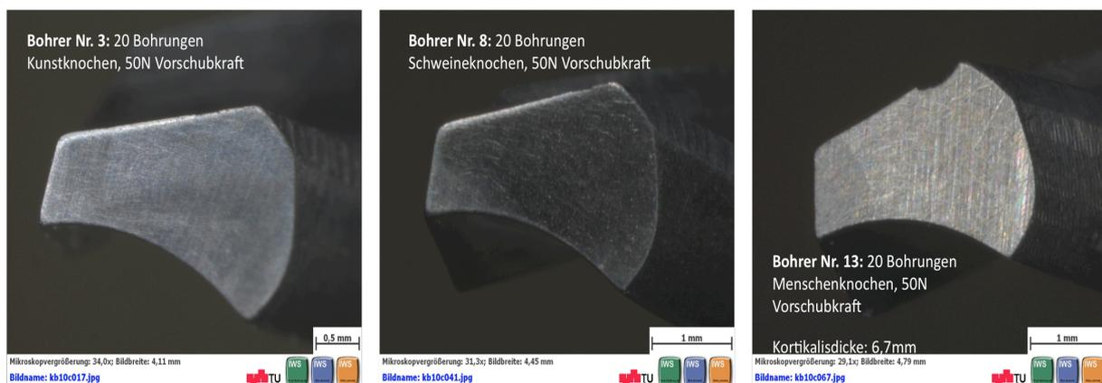
Abbildung 87: Verschleißerscheinungen bei Bohrungen in Kunst-, Schweine-, und Menschenknochen bei 20 Bohrungen mit je 50 N Vorschubkraft (Ebd.:46)
