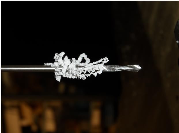
Abbildung 50: durchgehender Span (Aufnahmen aus Bohrversuchen)
