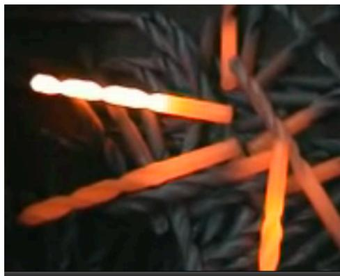
Abbildung 21: Spiralbohrer nach Walzvorgang (<http://www.ecef.eu/de/2011/10/produzione-di-una-punta-hss-da-trapano-per-rullatura/>)
