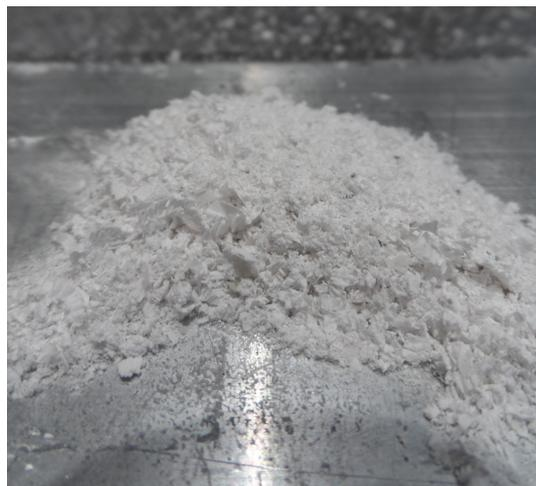
Abbildung 51: Bohrmehl (Aufnahme aus Bohrversuchen)
