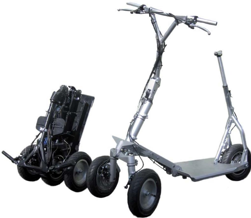
Abbildung 7.14.: Darstellung der Prototypenfahrzeuge im Fahrmodus und in der Abstellkonfiguration
