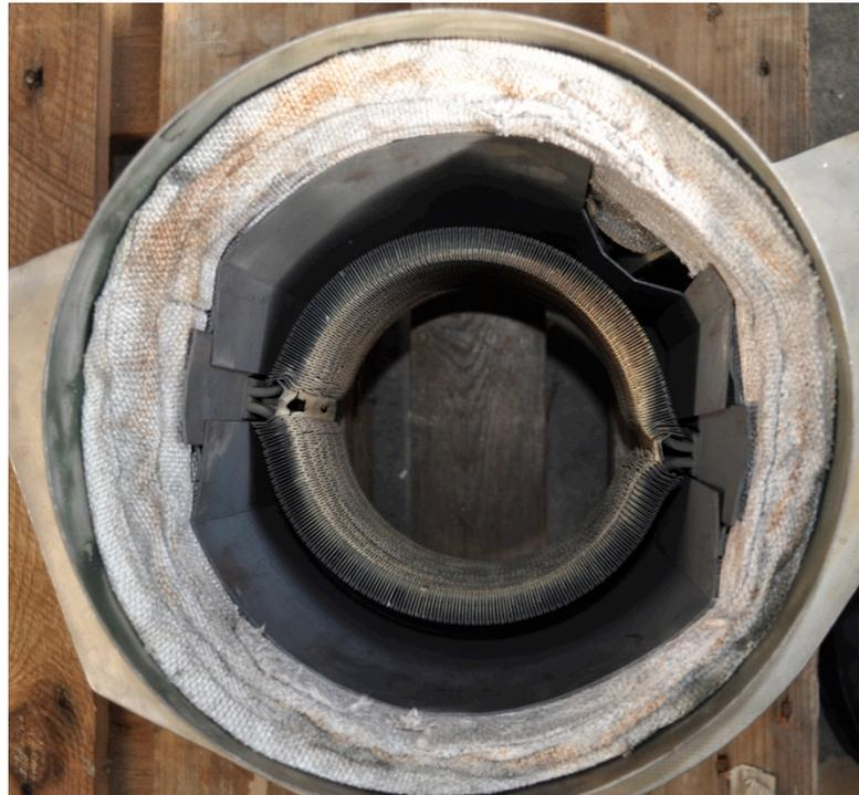
Abbildung 5-18: Wärmetauscher der heißen Maschinenseite (Expansionsraum)
