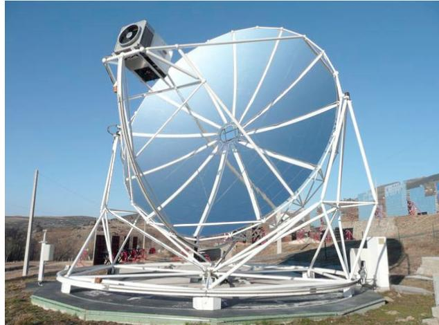
Abbildung 4-5: Dish-Stirling-System [53]
