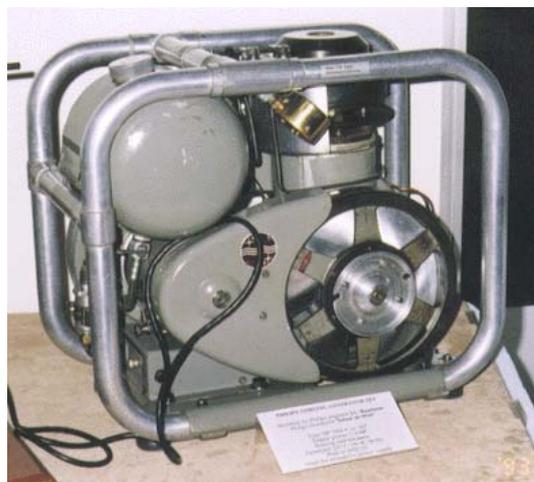
Abbildung 4-1: Mobiler Stirling-Generator von Philips aus den 50er-Jahren [48]
