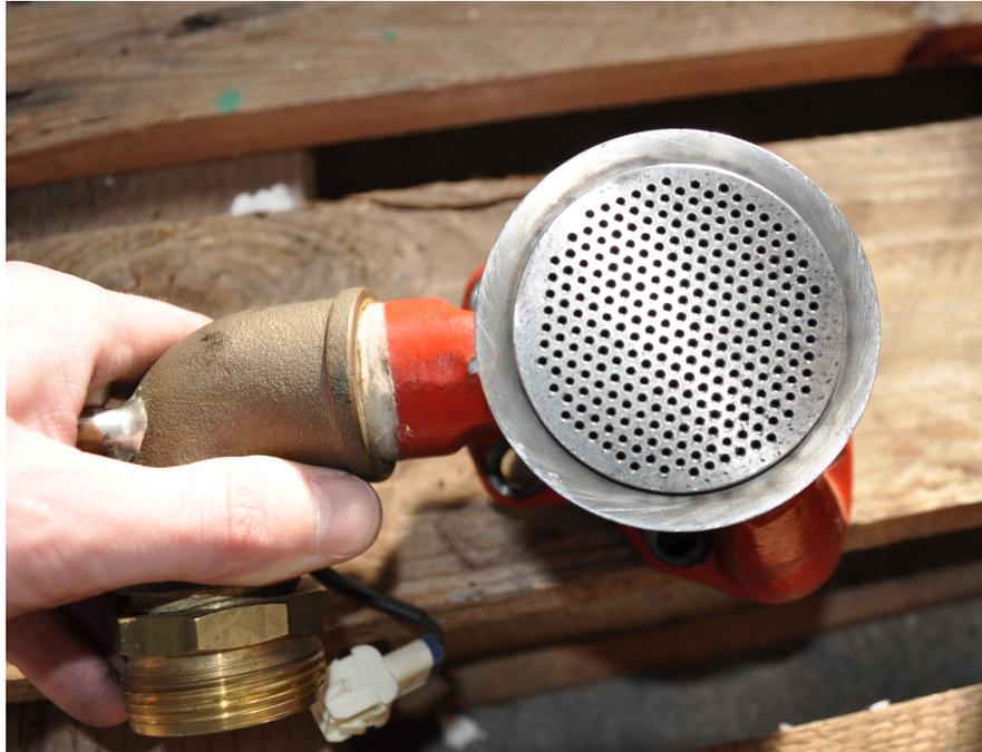
Abbildung 5-19: Wärmetauscher der kalten Maschinenseite (Kompressionsraum)
