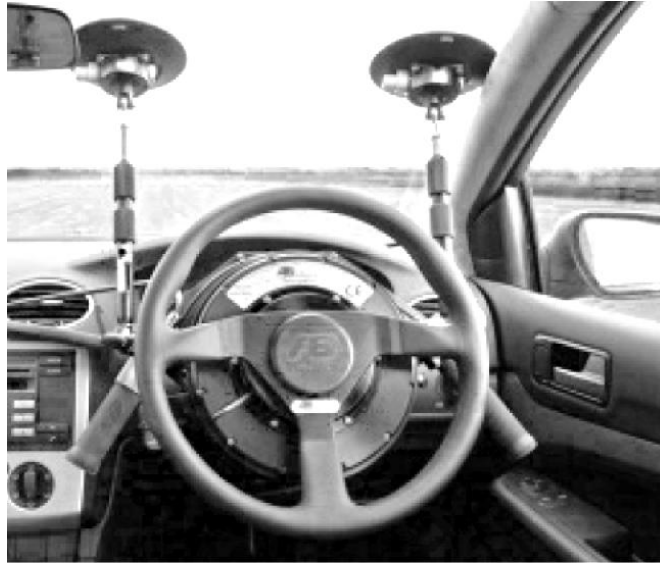
Abbildung 4.14 – Einbauposition eines Lenkroboters [ABD]
