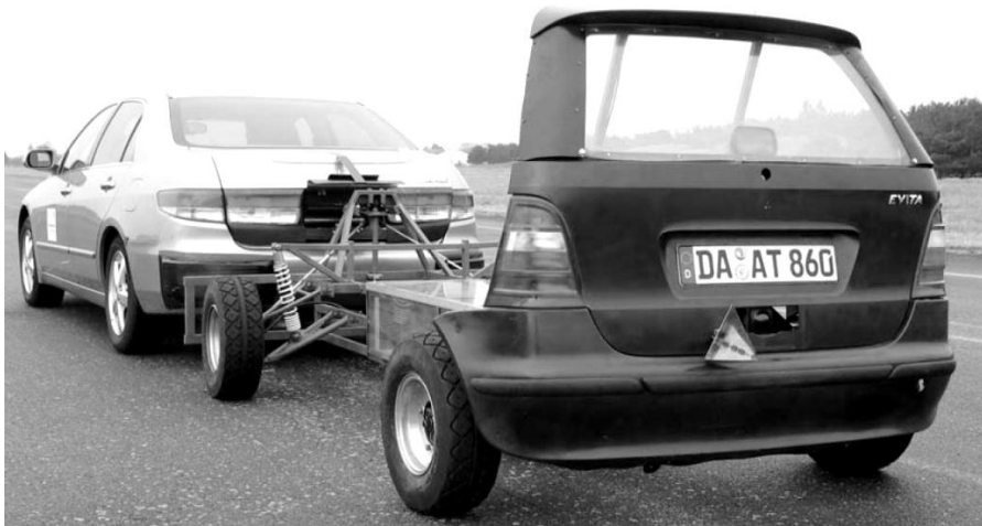
Abbildung 2.18 - Das Darmstädter Verfahren (EVITA) zum Testen und Bewerten von Frontalkollisionsgegenmaßnahmen [Hof08]
