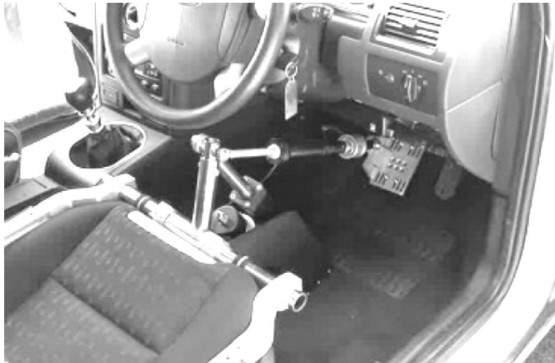
Abbildung 4.13 – Einbauposition eines Bremsroboters [ABD]
