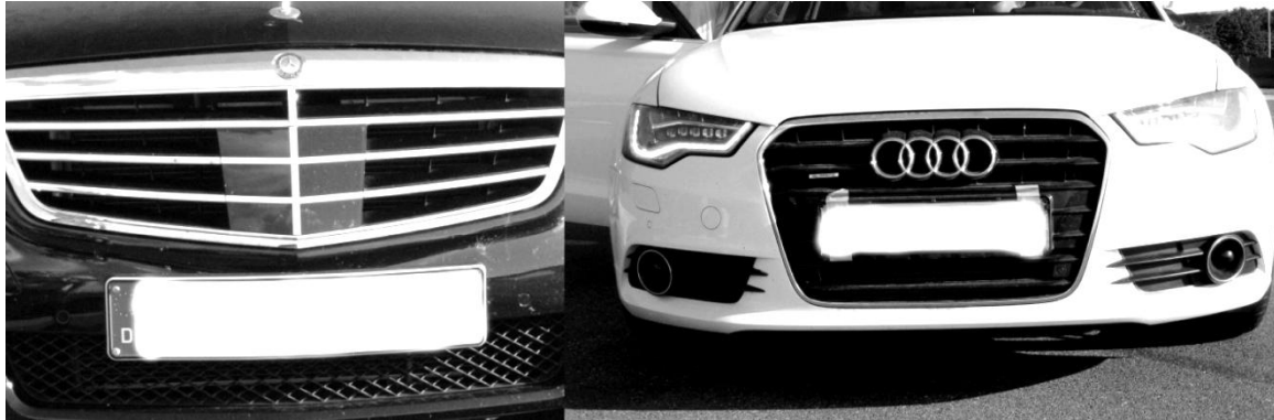
Abbildung 3.8 – Einbaupositionen von RADAR-Sensoren am Beispiel MERCEDES BENZ E-Klasse bzw.: AUDI A6
