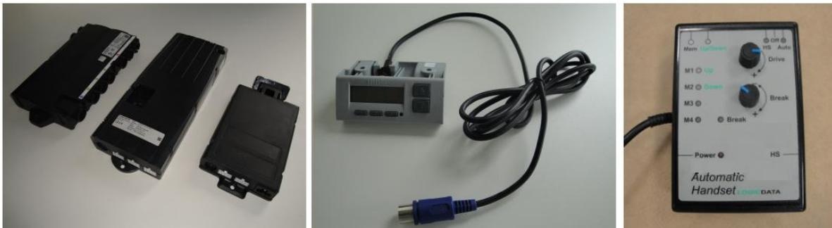
Abbildung 16: Steuerelektronik, v. l. n. r. Motorsteuerungen, digitaler Handschalter, analoger Handschalter
