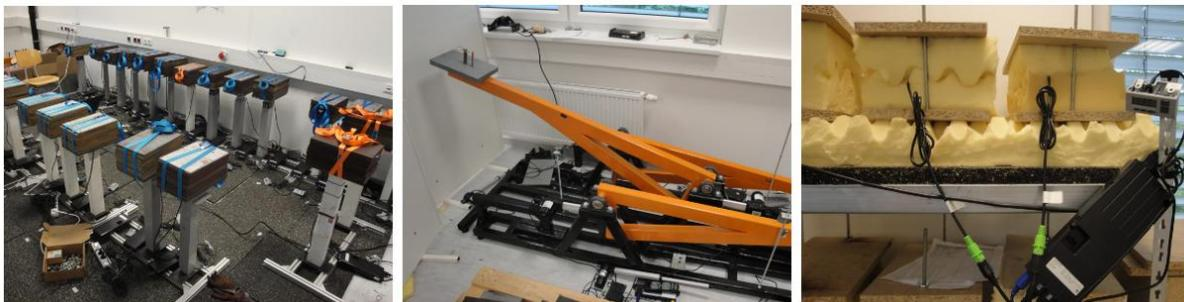
Abbildung 14: Dauerlaufprüfstände der Fa. LOGICDATA, v. l. n. r.: Säulenprüfstand, Hebelprüfstand, Massagemotorenprüfstand
