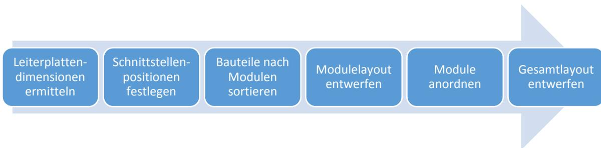
Abbildung 42: Schrittweises Vorgehen im Leiterplattenentwurf
