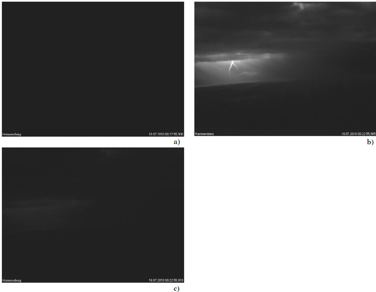
Abbildung 4: Drei Bilder einer Leaderentladung. Jedes Bild hat einen Belichtungszeitraum von 5 ms. Bild a) bis Bild c) sind in chronologischer Reihenfolge geordnet und belichten den Zeitraum von 18.07.2010 00:22:55:900 Uhr UTC bis 18.07.2010 00:22:55:915 Uhr UTC.
