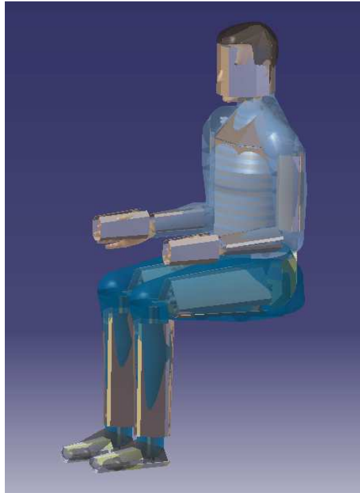
2-61: CATIA Manikin überblendet mit Klimadummy-Modell
