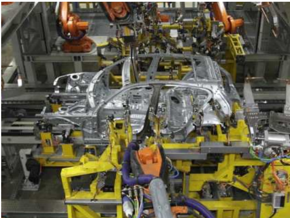
Abbildung 22: Karosserierohbau des BMW F20 170
