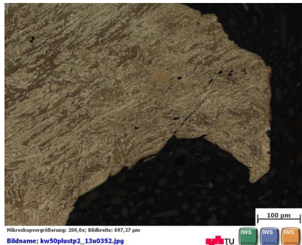
Abbildung 47: Kerbgrund der Probe S21_08 (SZ1), geätzt
