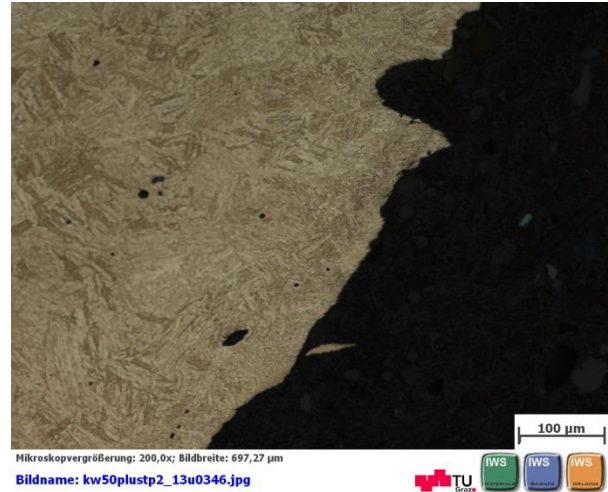
Abbildung 53: Kerbgrund der Probe S22_07 (SZ1), geätzt
