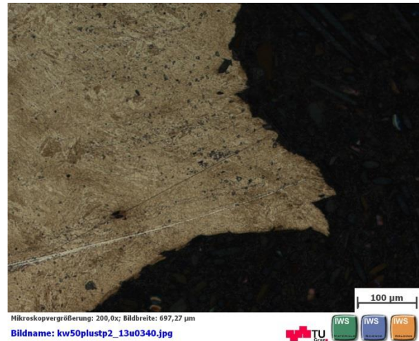
Abbildung 48: Kerbgrund der Probe S23_11 (SZ2), geätzt
