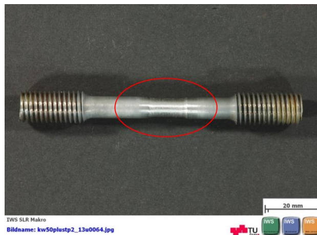
Abbildung 21: Verjüngung im simulierten Bereich an der Zugprobe
