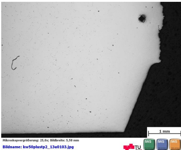
Abbildung 42: Kerbgrund der Probe S20_02 (SZ2), ungeätzt
