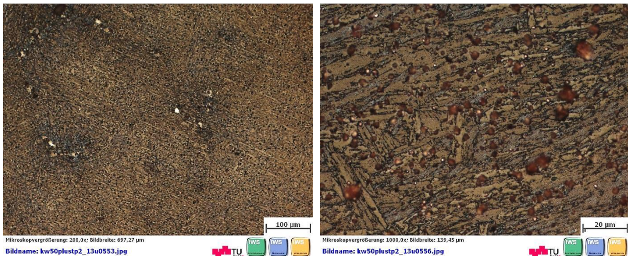
Abbildung 63: Probe S24_06 geätzt mit der Ätzung nach der mod. Winstead Ätzung
