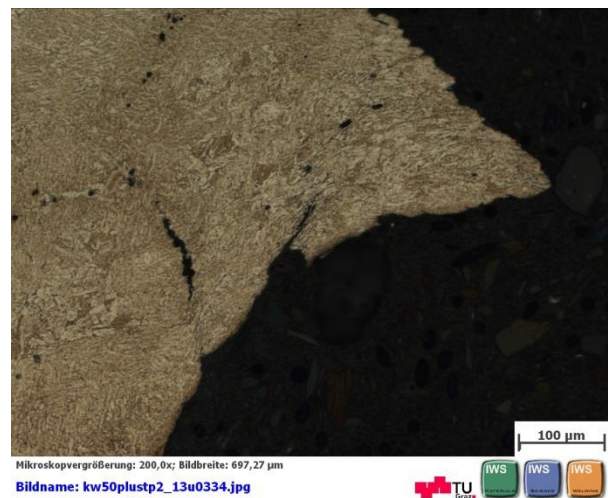
Abbildung 55: Kerbgrund der Probe S24_06 (SZ2), geätzt
