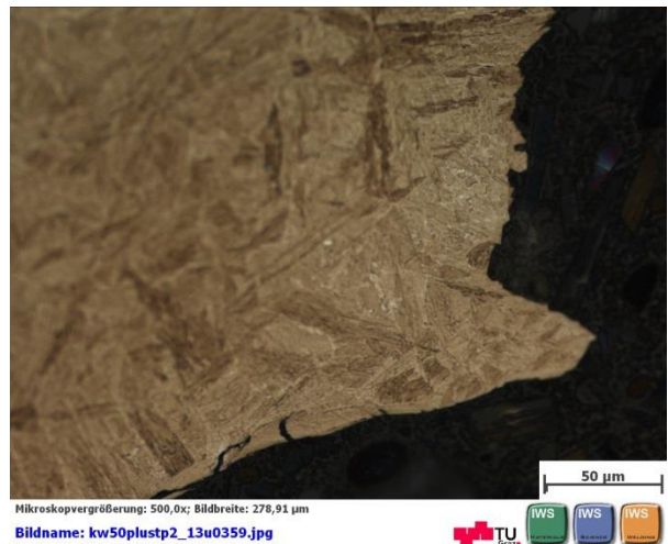
Abbildung 43: Kerbgrund der Probe S20_02 (SZ2), geätzt
