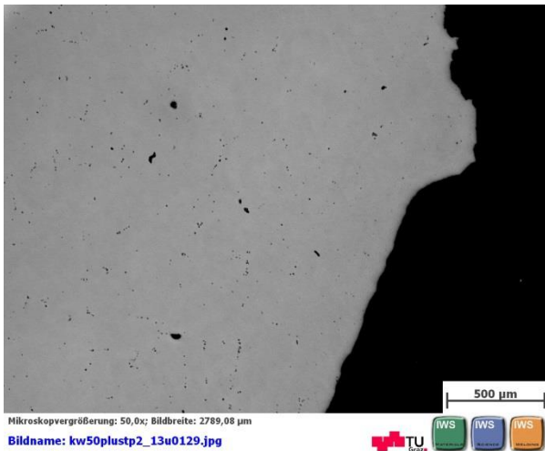
Abbildung 40: Kerbgrund der Probe S19_08 (SZ1), ungeätzt
