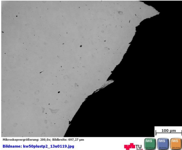
Abbildung 52: Kerbgrund der Probe S22_07 (SZ1), ungeätzt
