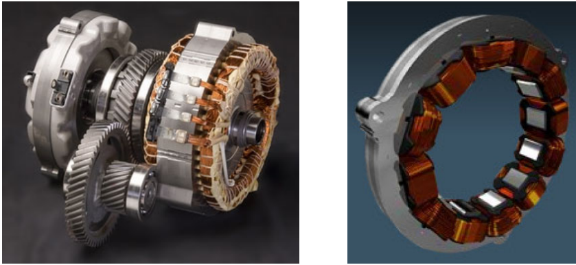
Abbildung 4-12: PMSM mit verteilter bzw. konzentrierter Wicklung [33]
