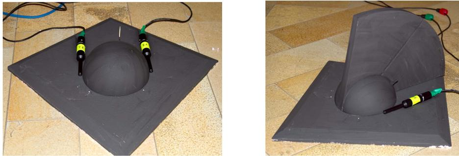
Abbildung 60: HKFM - 15cm aus Styropor, rechts: mit zusätzlicher Trennscheibe
