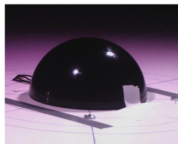
Abbildung 37: Kugelflächenmikrophon und Halbkugelflächenmikrophon im Messraum
