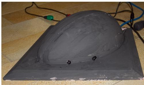
Abbildung 61: Ei als Trennkörper mit 4 eingebauten Mikrofonen
