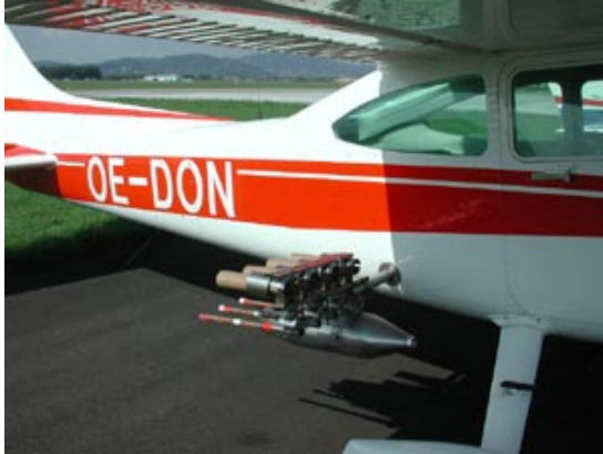
Abbildung 3.1: Hagelflugzeug mit AgJ-Brenner, AgJ- Fackeln und NaCl-Fackeln. von Hailair [2011]
