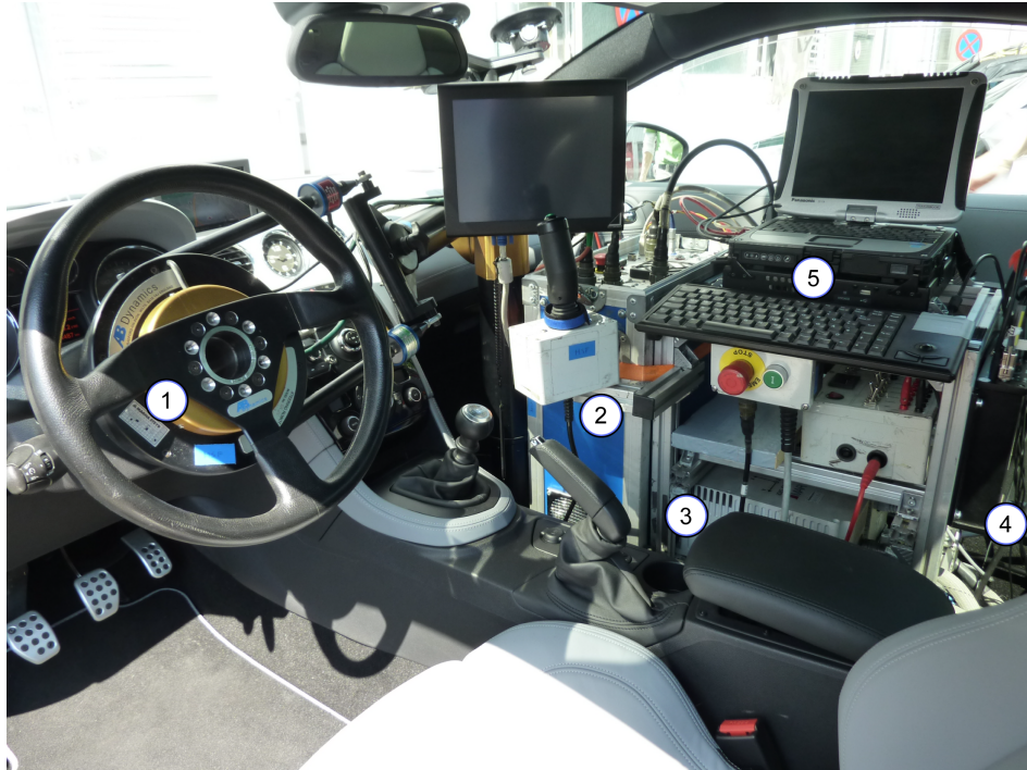
Abbildung 5-1: Messaufbau für Fahrdynamikmessungen
