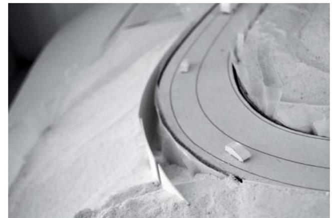
Variante 3: Wandschale in drei Teilen, in der Länge versetzt angeordnet; optisch in der Länge zerteilt; eindeutige Gehrichtung im Innenraum durch Öffnung des Innenraumes
