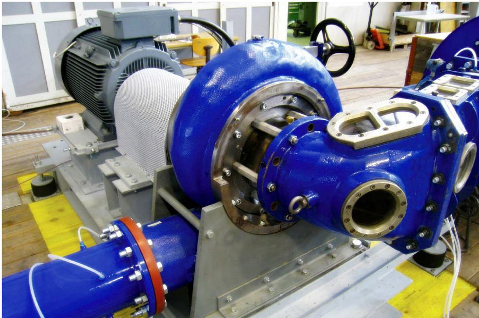
Abb. 1-7: Pumpturbinenprüfstand
