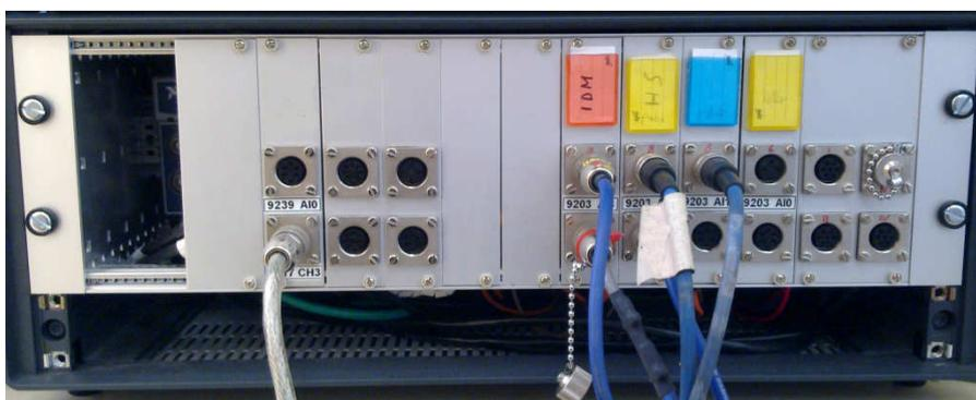
Abb. 1-8: National Instruments Messsystem
