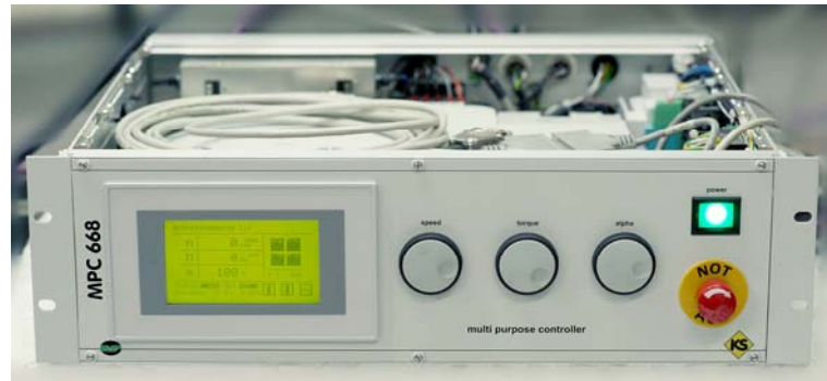
Abbildung 61: neuer Prüfstandsregler: KS MPC 668 (multi purpose controller)
