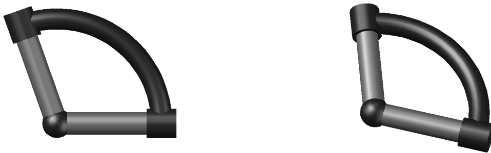
Abbildung 3.8: Verbindungsstücke zweier Nachbarfacetten ohne Drehgelenke für die drei Trägerschichten
