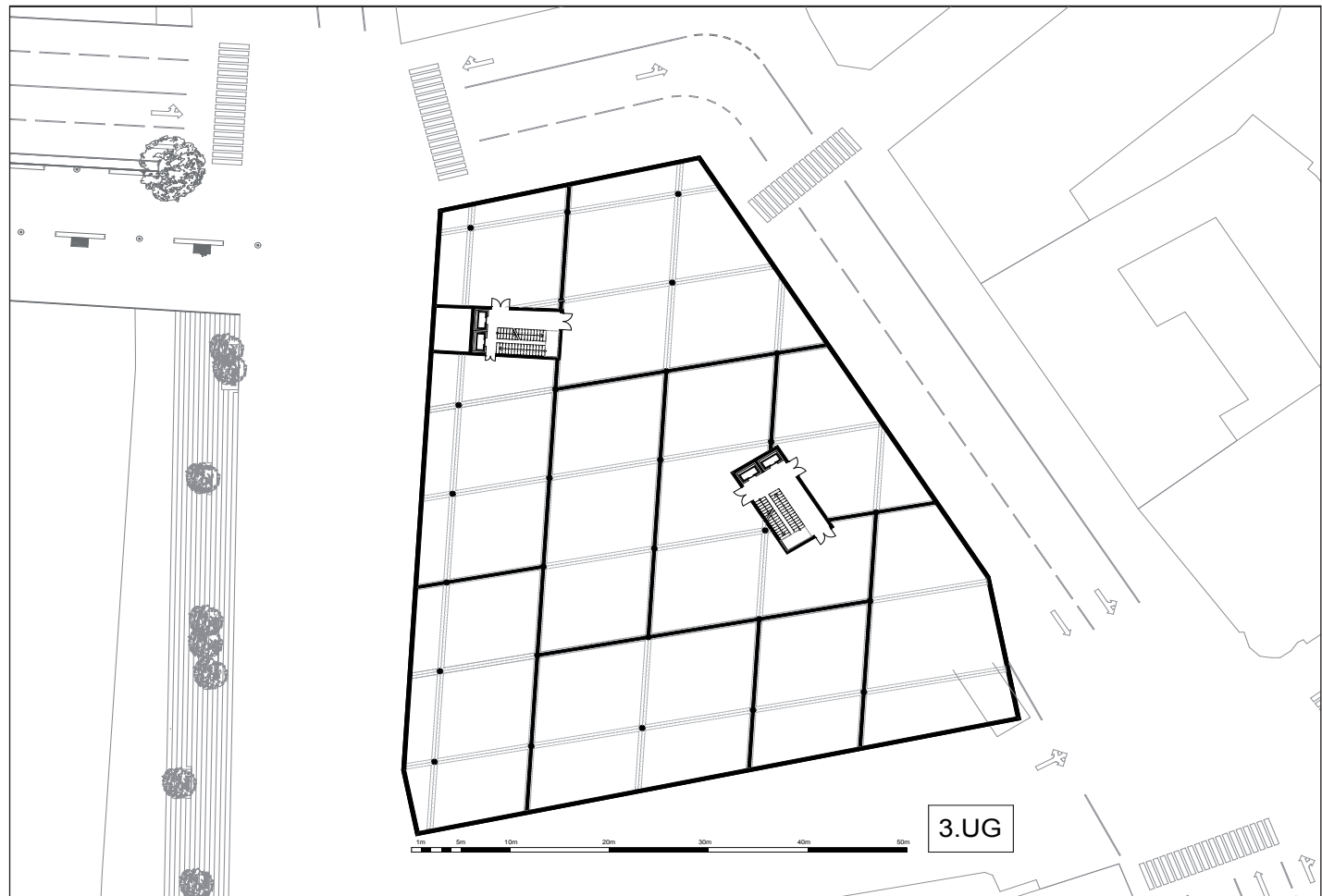
Abb.112 Grundriss 3.UG: Technikgeschoss
