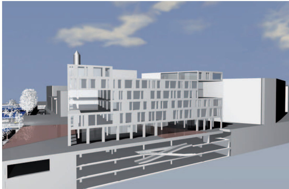
Abb.74 3-D-Schnitt Tiefgarage und Unterführung
