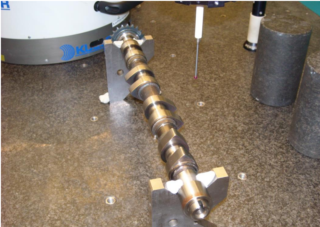
Abbildung 4.11: Vermessung der Nockenkontur (Auslass)
