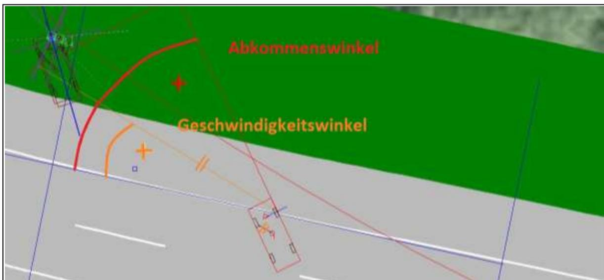
Abbildung 30: Abkommenswinkel, Geschwindigkeitswinkel [28, 2010a]
