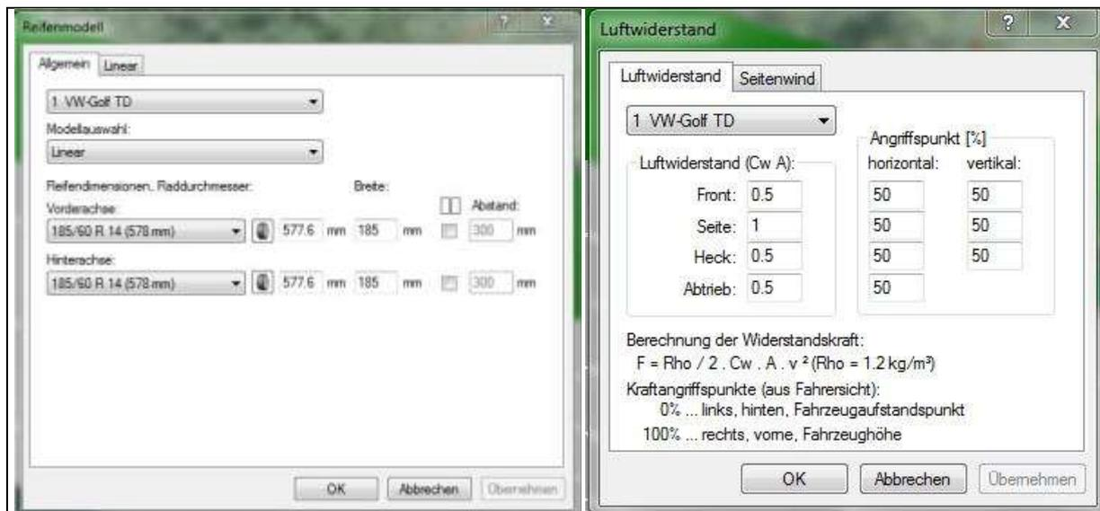
Abbildung 25: Reifenmodell, Luftwiderstand [28, 2010a]
