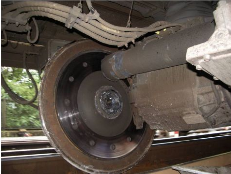
Abbildung 1.2: Gebrochene Radsatzwelle des ICE3 in Köln
