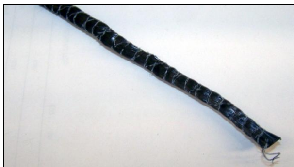
Abbildung 3-8 In der Felge eingesetztes geheftetes Roving
