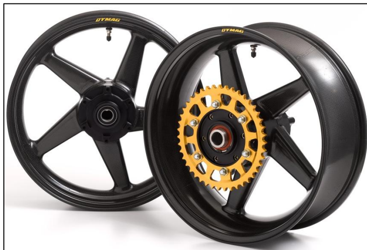
Abbildung 8-3 Derzeit erhältliches Kohlenstofffaser-Epoxy-Verbund-Rad für Motorräder (18)
