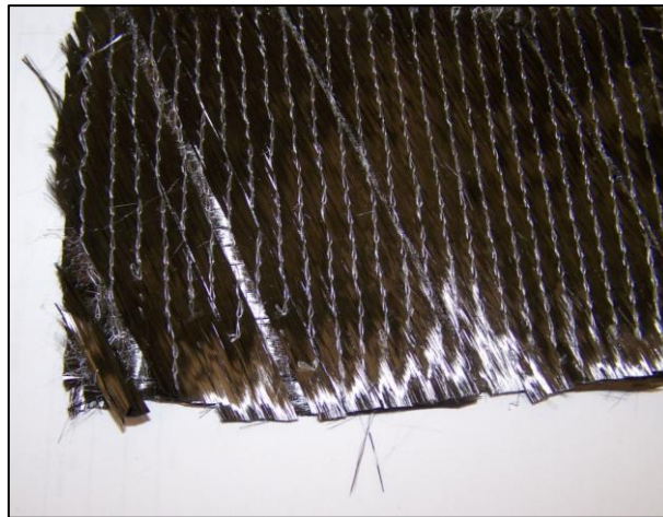
Abbildung 3-6 In der Felge eingesetztes Triax-Gelege
