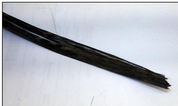
Abbildung 3-7 In der Felge eingesetztes loses Roving
