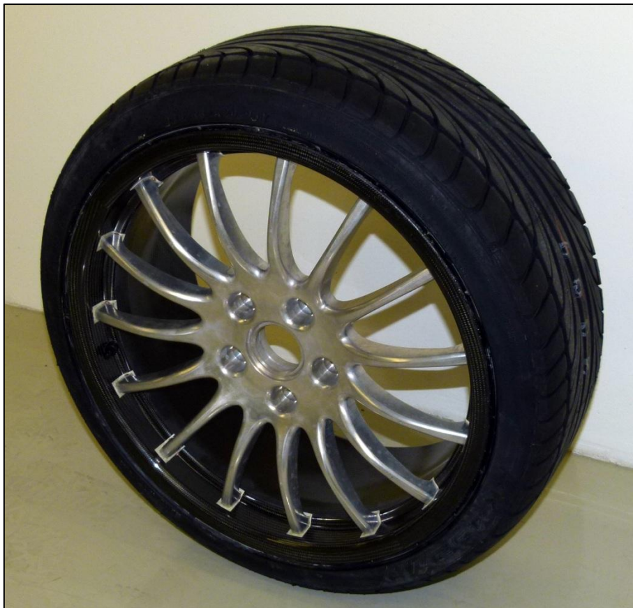
Abbildung 2-1 Foto des 20 Zoll Karbon-Aluminium Rad Prototyps
