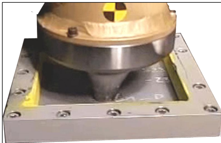
Abbildung 6-39 Kugelschlagversuch, Foto der Intrusion aus der Übersichts-HS-Video Aufnahme
