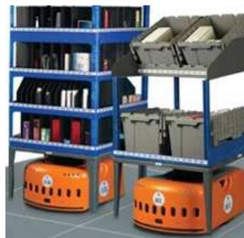
Abbildung 3-5: Unterfahrschlepper Kiva von QuietLogistics
