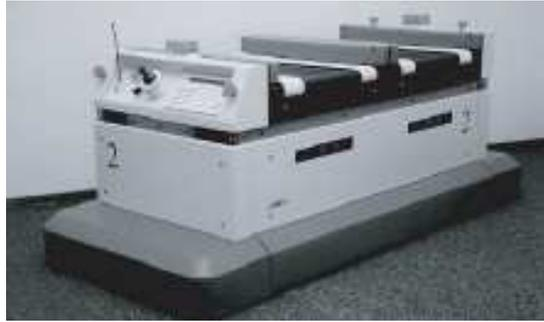
**Abbildung 3-2: FTF mit 2 LAM zur mehrfachen Lastaufnahme (nach [VDI05] , Fig. 6)**
