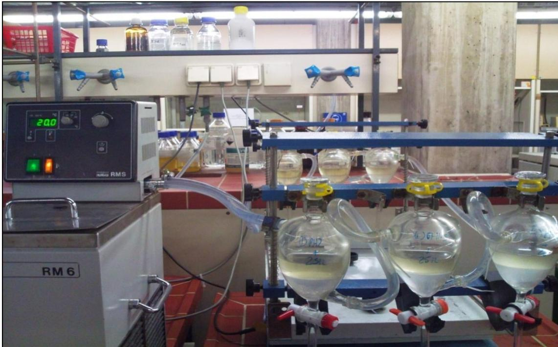
Abbildung 8: Apparatur zur Bestimmung des Phasengleichgewichtes
