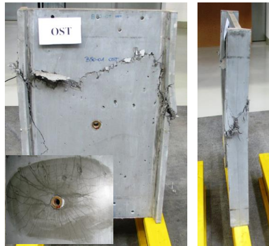
Bild 4-100 Bruchbild im Versuchskörper 50-01
