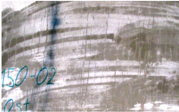
Bild 4-185 Rissbildung an der Stelle 2 (Links) und an der Stelle 3 (Rechts)
