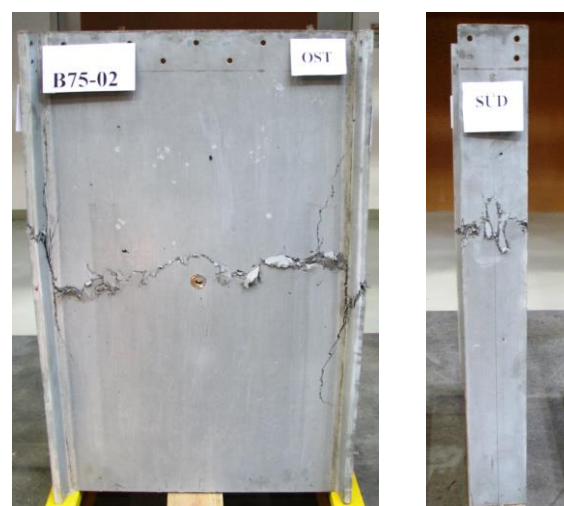
Bild 4-113 Bruchbild im Versuchskörper 75-02
