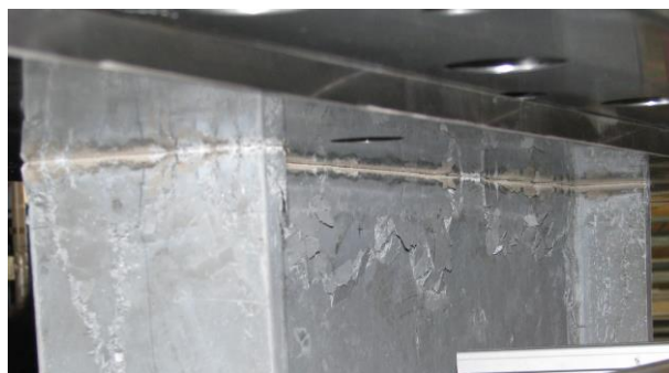
Bild 4-109 Bruchbild im Versuchskörper 75-03
