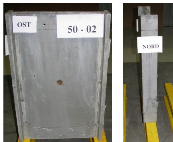
Bild 4-102 Bruchbild im Versuchskörper 50-02
