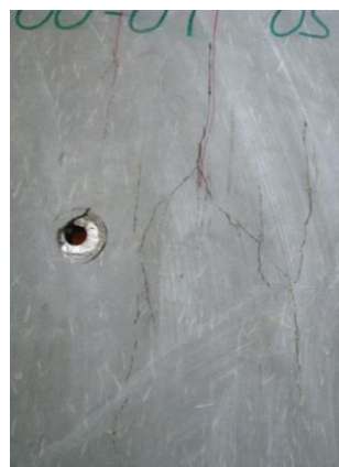
Bild 4-198 Rissbildung in der Scheibemitte (links, Mitte)
