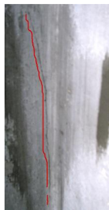
Bild 4-154 Rissbildung in den Flanschen –Außenseite
