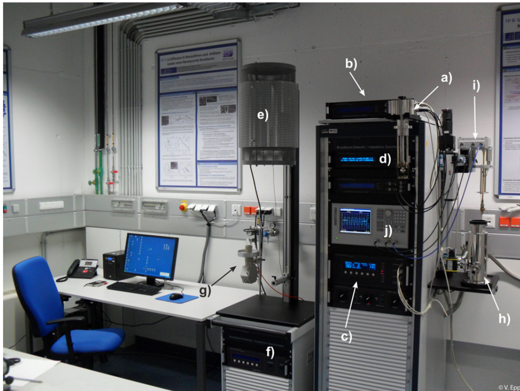
Abbildung A.3: Novocontrol Breitband-Spektrometer Concept 80 für dielektrische Messungen von wenigen \mu\text{Hz} bis 20 MHz. a) ZGS-Messzelle, b) ZG4-Schnittstelle, c) AUSTRO-Temperatursteuerung, d) Alpha-A-Analyzer, e) Hochtemperaturofen bis 1870 K, g) NorECs Hochtemperaturzelle, h) Dewar zum Erhalten der Temperatur an der Messzelle mit einer Genauigkeit von \pm 0.1 K, i) Hochfrequenzzelle mit zugehörigem Agilent E4991 Hochfrequenz-Impedanzanalysator, j), für einen Frequenzbereich von 1 MHz bis zu 3 GHz. Das System wird über den PC mit der WinDETA-Software gesteuert.
