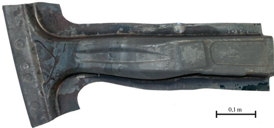
Abbildung 23: Presshärtparteil verkürzte B-Säule, hergestellt mit dem Versuchswerkzeug aus Abbildung 24; eigene Darstellung
