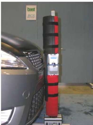
Abb. 65 und 66: Ursprüngliche Fleischsimulation des FlexPLI Version GTR (links) sowie die als Folge der instabilen Testergebnisse geänderte Variante mit über die gesamte Länge des Prüfkörpers reichenden Gummilagen (rechts) (Leßmann/Gehring 2009, S. 23)
