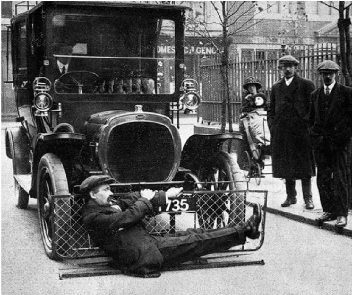
Abb. 2: Mit einem Netz und einem automatisch ausklappenden Gestänge wurden Fußgänger bei einem Unfall aufgefangen (Gloor 2006, S. 45 nach „Automobil Revue“ Nr. 49/1913).
