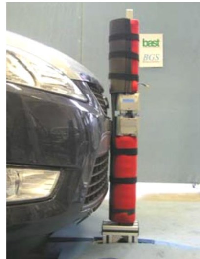
Abb. 65 und 66: Ursprüngliche Fleischsimulation des FlexPLI Version GTR (links) sowie die als Folge der instabilen Testergebnisse geänderte Variante mit über die gesamte Länge des Prüfkörpers reichenden Gummilagen (rechts) (Leßmann/Gehring 2009, S. 23)
