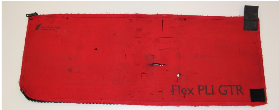
Abb. 72: Deutlich erkennbare Schäden an der Neopren-Außenhaut des FlexPLI, vermutlich verursacht durch das Einklemmen/Quetschen des Neopren zwischen dem Testobjekt und dem Knieelement (Kinsky 2011b, S. 4)
