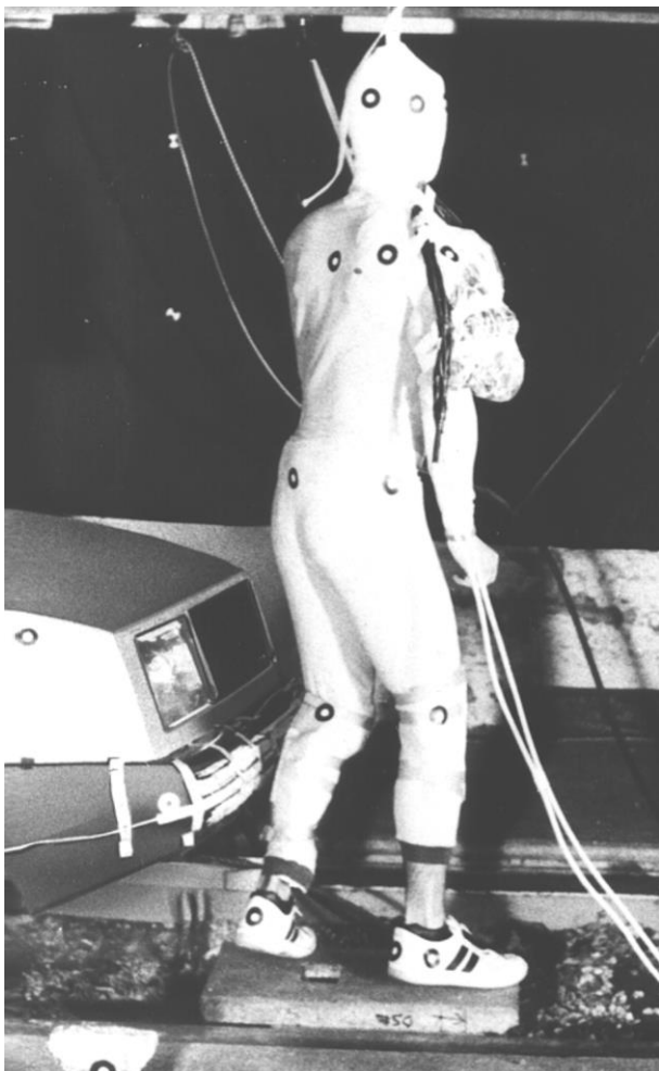
Abb. 32: PMTO-Positionierung vor dem Test (Kallieris/Schmidt/Miltner 1991, S. 18)
