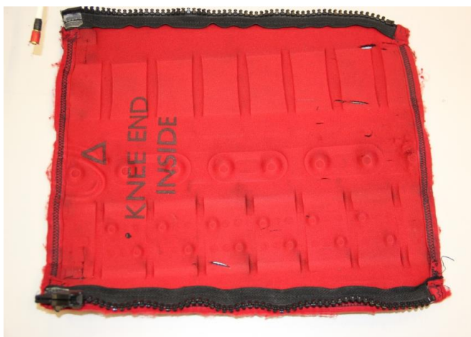
Abb. 75: Deutliche Abdrücke der einzelnen Segmente von Schienbein bzw. Oberschenkel auf der Innenseite der Neopren-Außenhaut (Kinsky 2011b, S. 5)
