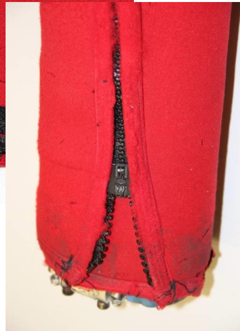
Abb. 73 und 74: Verschlissener Reißverschluss mit fehlendem Schiebergriff (Kinsky 2011b, S. 4f)
