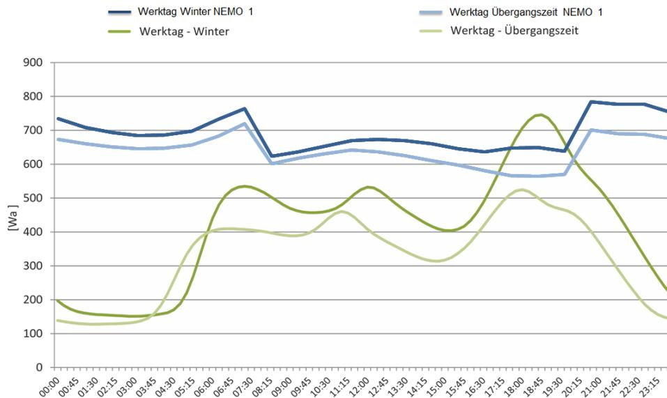
ABBILDUNG 6: VERGLEICH AUSGEWÄHLTER TEILE DES STANDARDLASTPROFILS H0 MIT DEM NEMO I GUTACHTEN (QUELLEN: (APCS, 2013) (CONSENTEC, 2012A); EIGENE DARSTELLUNG)
