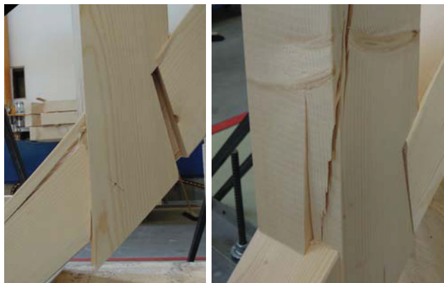
Bild 4D.14 VM 4: Schub und Rollschub, Seitenansichten von Prüfkörpern, Links: W45_400-2, Rechts: W45_500-1.
