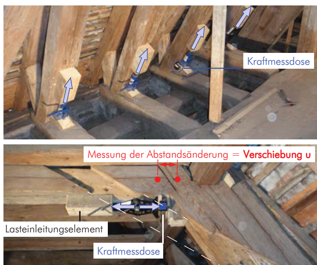
Bild 4A.36 Prüfungsaufbauten, Oben: an Sparrenfüßen, Unten: an einem Spannriegel (vgl. ZEHETGRUBER (2010)).
