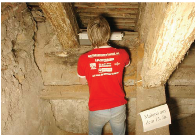
Bild A.46 Links: Bohrwiderstandsmessung durch einen Sparren, Rechts: Fruchtkörper des „Weißen Porenschwammes“. Fig. A.46 Left: drilling resistance measurement through a rafter rotten inside, Right: fruiting body of the "white pore sponge".
