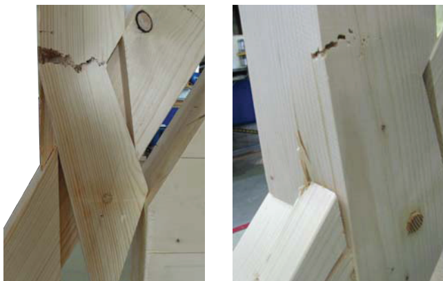
Bild 4D.12 VM 2: Biegezug im Blatt, Seitenansichten von Prüfkörpern, Links: W30_450-1-HN, Rechts: W45_400-2-HN.
