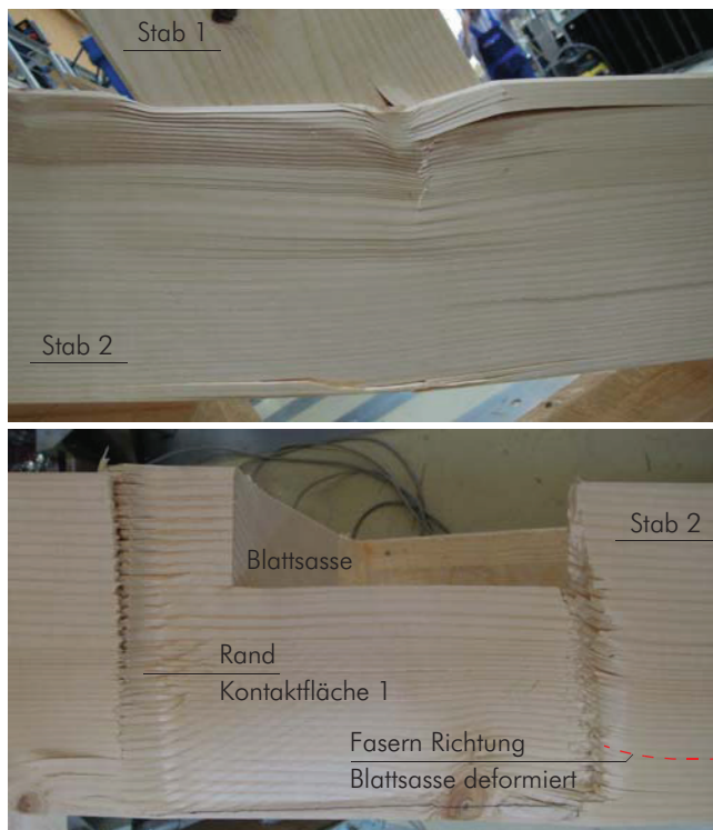
Bild 4D.11 VM 1: Querdruck, Prüfkörper W60_400-1, Oben: Seitenansicht, Unten: Draufsicht auf Stab 2.
