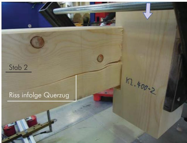
Bild 4E.12 Prüfkörper K2_400-2 mit Kamm auf der lastabgewandten Seite während der Prüfung.
