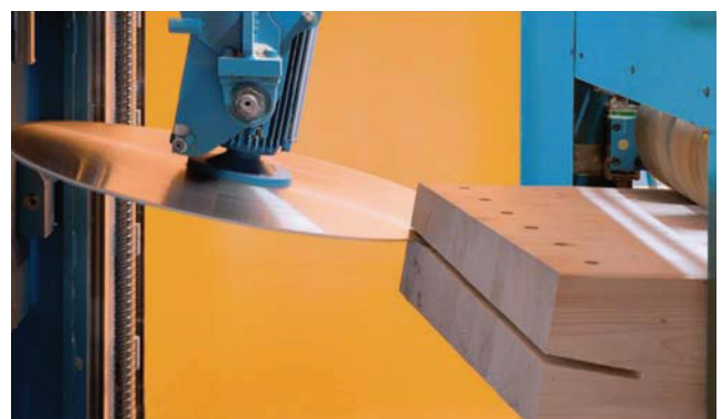
Bild 6.7 Vollautomatischer Abbund einer Stabdübelverbindung, HUNDEGGER (2014).
