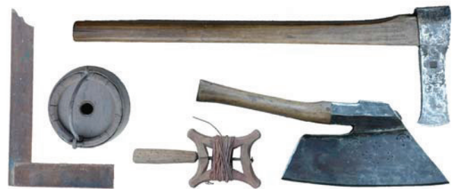
Bild 2.2 Typische Werkzeuge zum Beschlagen der Konstruktionshölzer, 18. Jh. (vgl. ZACH (2009)).
