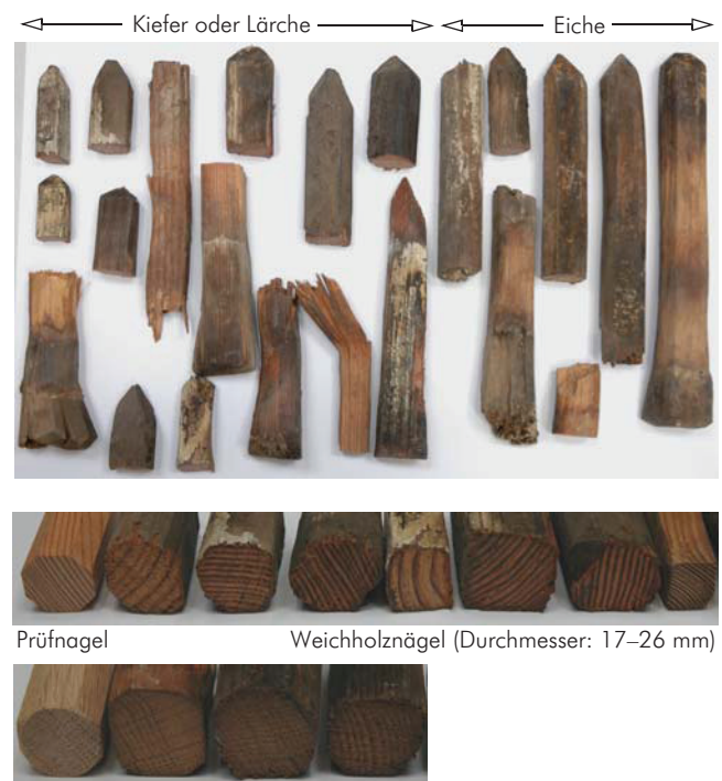
Bild 4C.4 Typische Holznägel aus Graz (Österreich).
