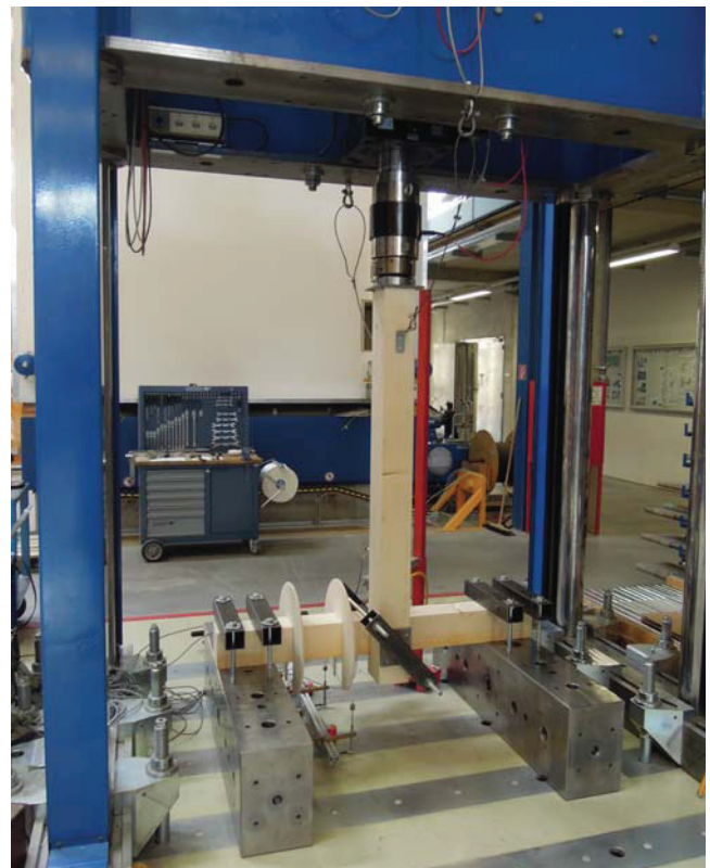
Bild 4E.7 Prüfkörper K4_400-1 im Prüfgerüst.
