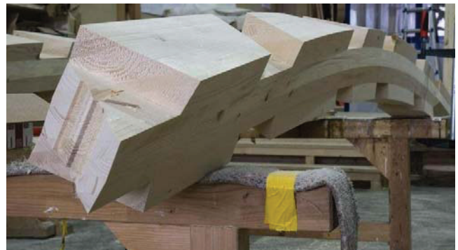
Bild 6.11 Oben: Golfclub Hasley-Nine Bridges in Yeosu/Südkorea, JAERMANN (2012), unten: eines von 3.490 CNC-gefertigten Bauteilen (ANTEMANN (2009)).
