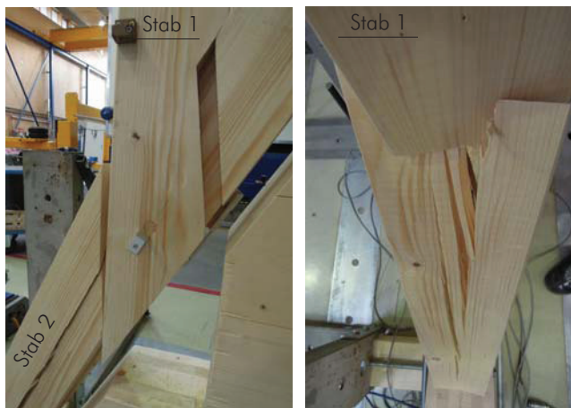
Bild 4D.13 VM 3: Schub, Rollschub und Querkzug, Links: Seitenansicht, Rechts: Draufsicht auf das Vorholz von Prüfkörper W30_450-2-HN.
